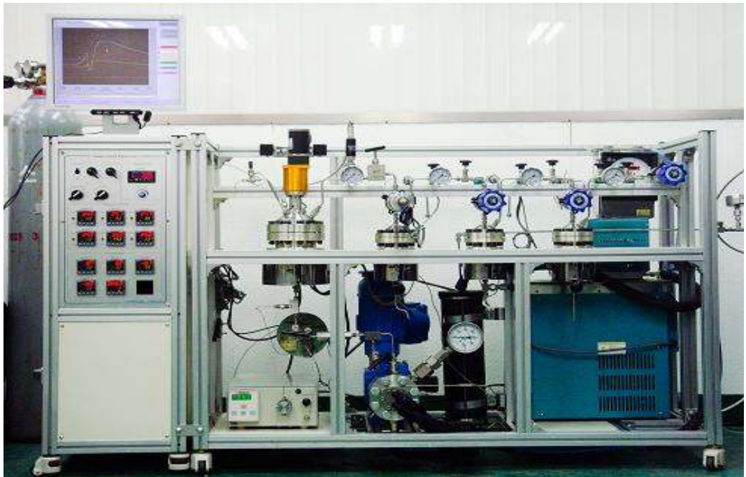
그림 17. 인지질과 지방산의 분리 추출 공정에 사용된 랩용 초임계 플랜트
