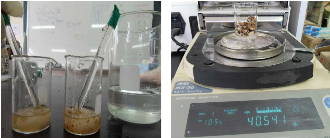
<그림 2-6> 알파셀룰로오스 실험모습(좌) 및 유리거르개에 담긴 건조시료 무게 측정모습(우)
