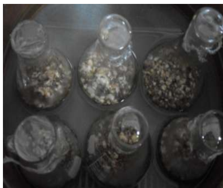
<그림 2-5> 염소가스 반응 전 폐면의 모습(좌) 및 탈리그닌화가 진행중인 폐면(우)
