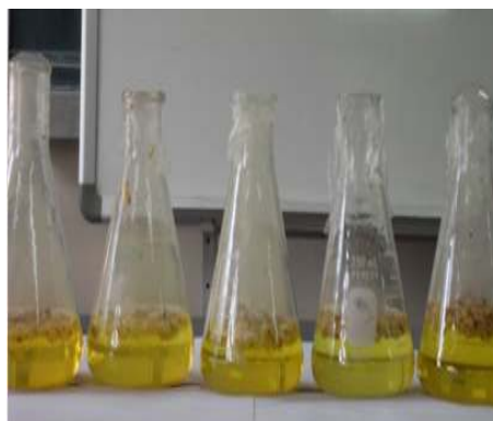
<그림 2-5> 염소가스 반응 전 폐면의 모습(좌) 및 탈리그닌화가 진행중인 폐면(우)
