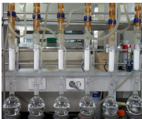
<그림 2-2> 폐면의 유기용매 추출모습(좌) 및 후드 내에서 원통여과지 내의 잔여 용매를 휘발시키는 모습(우)
