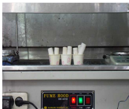
<그림 2-2> 폐면의 유기용매 추출모습(좌) 및 후드 내에서 원통여과지 내의 잔여 용매를 휘발시키는 모습(우)
