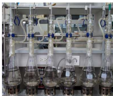
<그림 2-4> 폐면 내 72% 황산 주가 모습(좌) 및 리그닌 정량을 위해 환류냉각장치에 장착된 모습(우)
