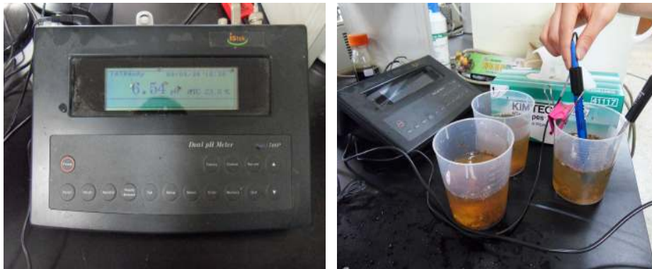
<그림 1-1> pH 측정기(좌) 및 측정 방법(우)
