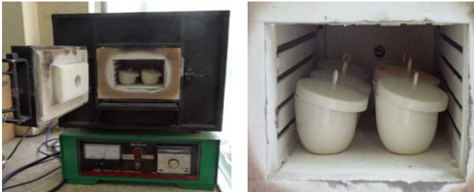
<그림 1-3> 회분기(furnace) (좌) 및 회분기 내 도가니가 투입된 모습(우)
