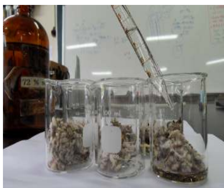
<그림 2-4> 폐면 내 72% 황산 주가 모습(좌) 및 리그닌 정량을 위해 환류냉각장치에 장착된 모습(우)
