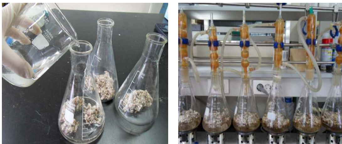
<그림 2-3> 폐면 내 증류수 추가(좌) 및 환류냉각장치를 이용한 온수추출 모습(우)
