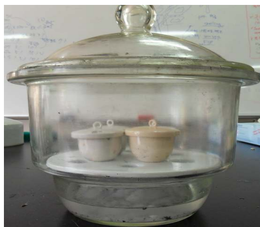
<그림 2-1> 회분용 시료 무게 측정(좌) 및 데시케이터 내 도가니 모습(우)
