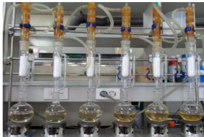
<그림 1-4> 속슬레(soxlet) 추출관에 환류냉각기를 장착한 모습
