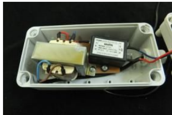
그림 3-2-9. 실험에 사용한 노이즈필터 콘센트와 내부 구성
