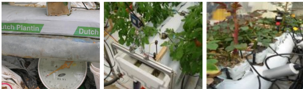
그림 1-1-7. 배지의 함수량을 측정하는 다양한 방법들 (좌로부터 중량법, 배액전극센서, 배지수분센서)
