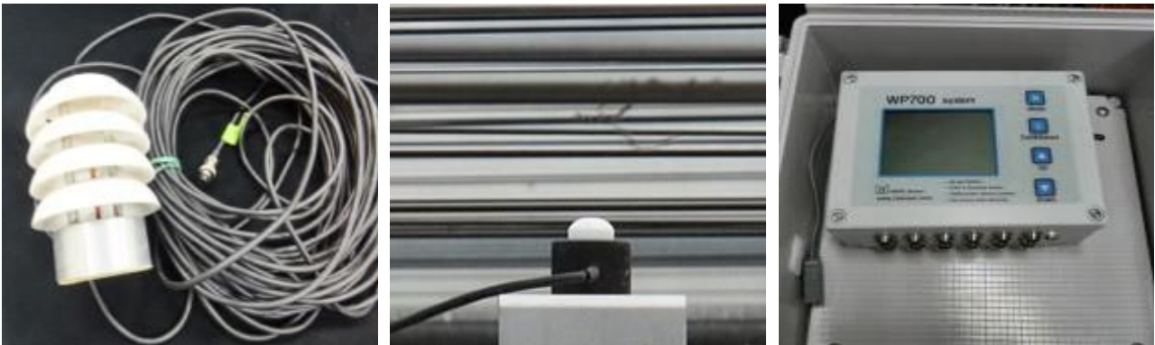
그림 3-5-1. 실험에 사용한 대기온습도 센서, 일사량 센서와 데이터 로거
