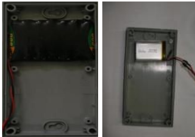
그림 3-1-8. 기존 배터리, 교체한 배터리 사진
