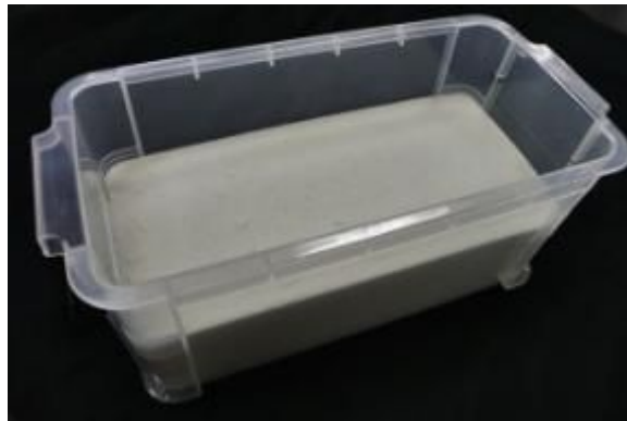
그림 3-1-1. 수분 센서 calibration을 위한 glass bead
