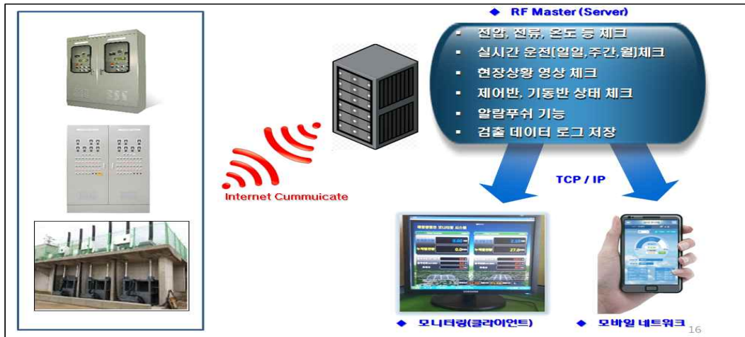
Fig. 40 PC 및 스마트폰 원격 모니터링 · 제어 시스템
