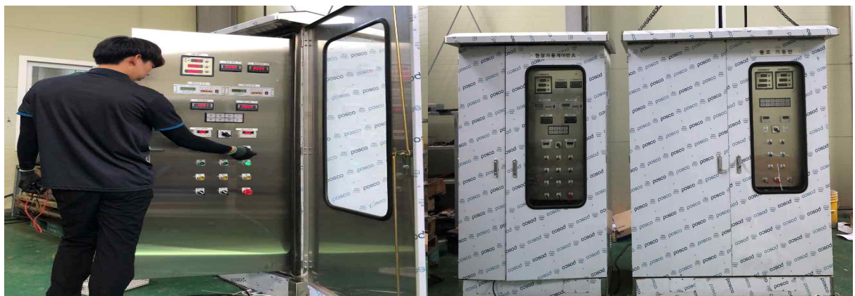
Fig. 168 자동제어반 및 펌프기동반 제작완료
