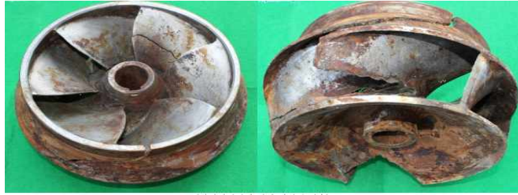
Fig. 60 캐비테이션에 의한 임펠러 파손
