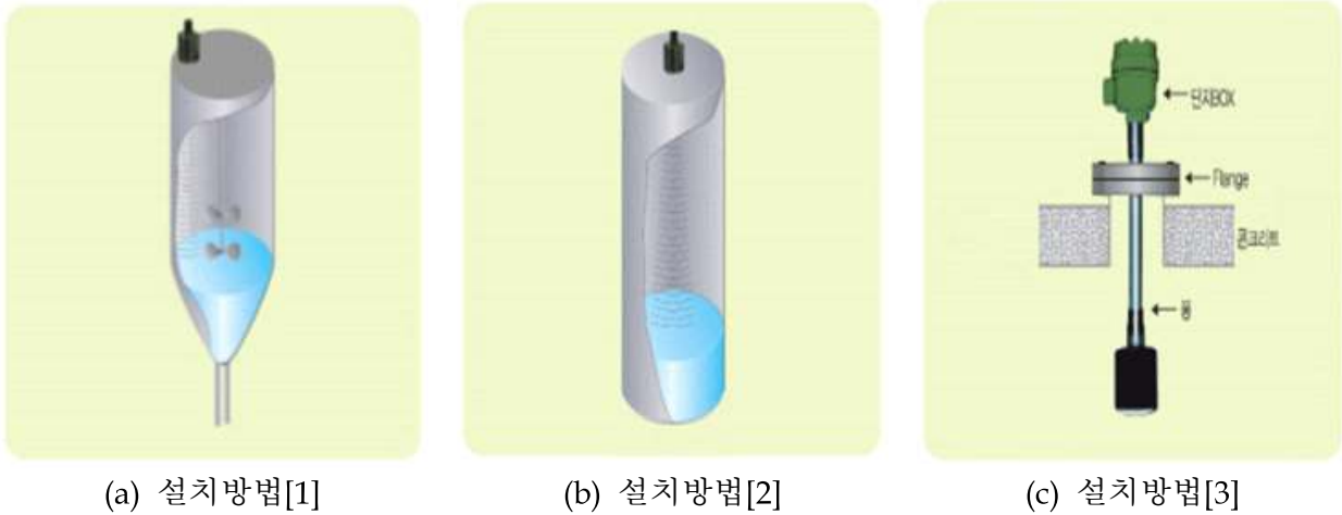
Fig. 51 초음파 수위센서 설치 예
