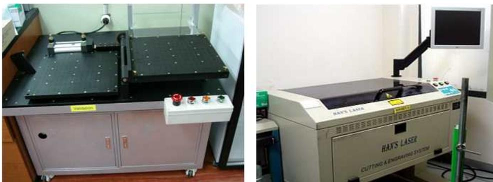
그림 12. Lab-on-a-film 칩 조립 및 커팅 장비.
