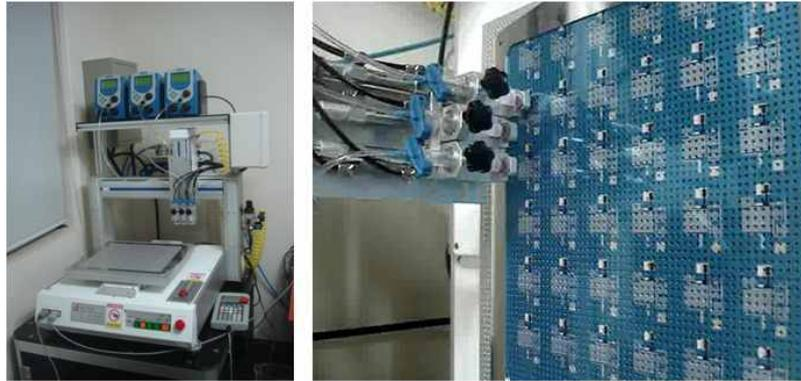
그림 11. Lab-on-a-film 칩 시약 분주 장비; 디스펜서.
