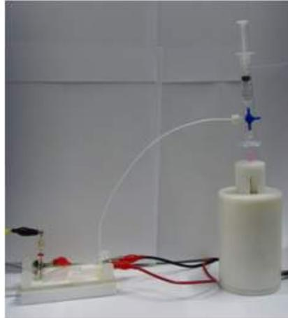
그림 49. microfluidic chip 시스템 및 간이전처리기 결합도.
