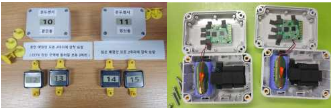
그림 58 축사 환경과 모돈에 부착되는 센서
