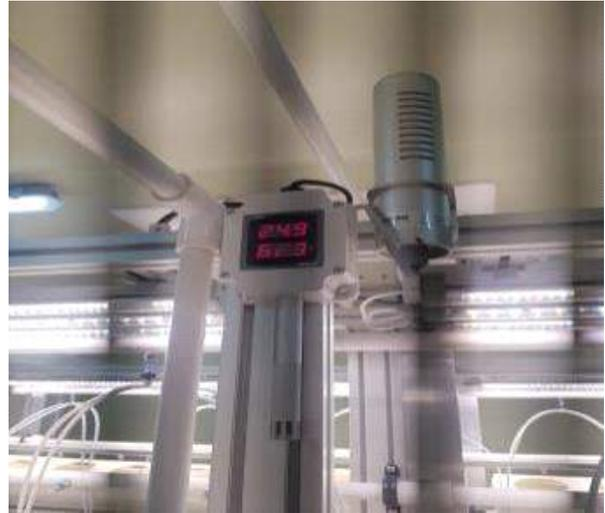
그림 34. 온/습도, CO<sub>2</sub> 센서 설치
