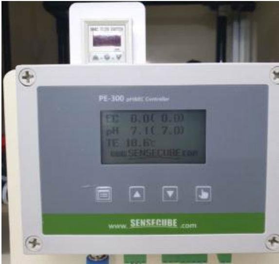
그림 17. pH, EC 및 유량 센서
