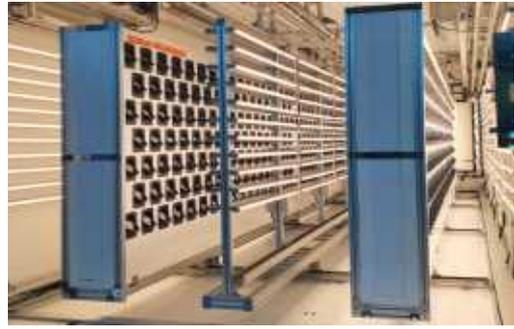
그림 9. 이동형 재배대, LED모듈 시스템
