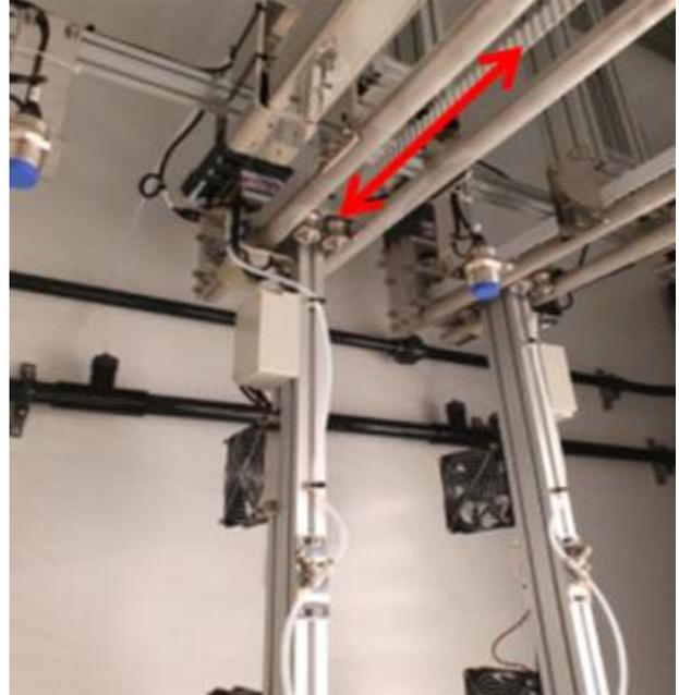
그림 14. 수분 유도 Fan 이동 장치
