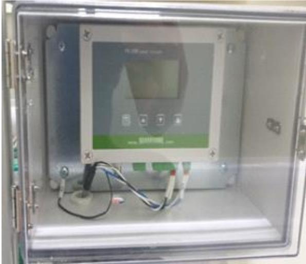
그림 33. pH & EC 센서 모니터링 장치
