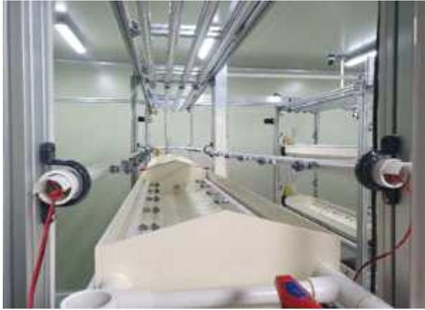
그림 23. 진동모터 설치 & 결선
