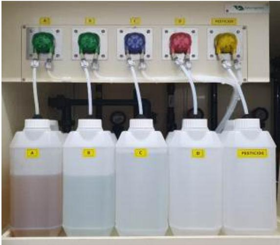
그림 15. 양액 자동 조제/공급 시스템
