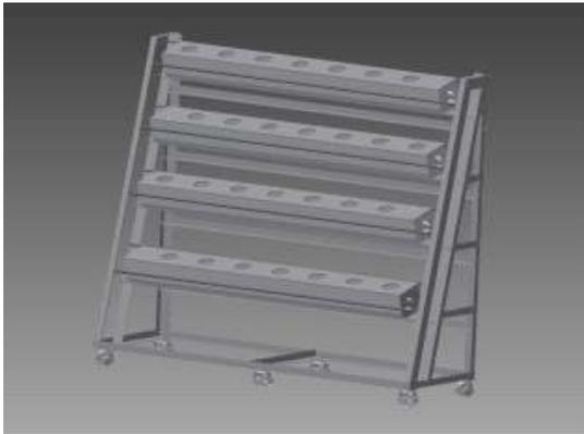
그림 21. 계단형 재배시스템 3D 모델링
