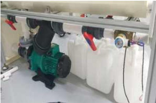
그림 25. 급수용 공급 펌프 설치
