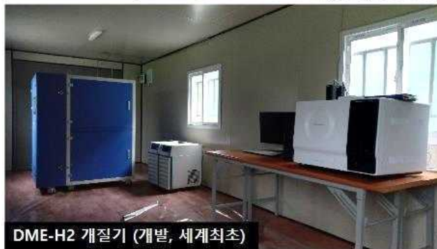
[DME 탱크와 연결된 배관과 DME-H2 개질기의 Feed Gas 주입구를 연결하여, DME-H2 개질기에서 연속적으로 Reforming이 가능하도록 Setting 하였음]
