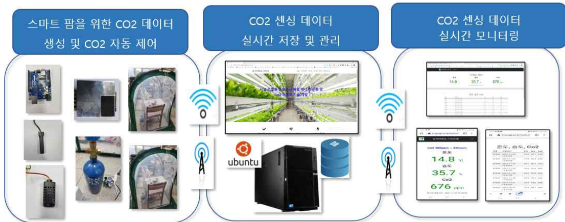
[이산화탄소 센서 데이터 실시간 모니터링 시스템 구축]
