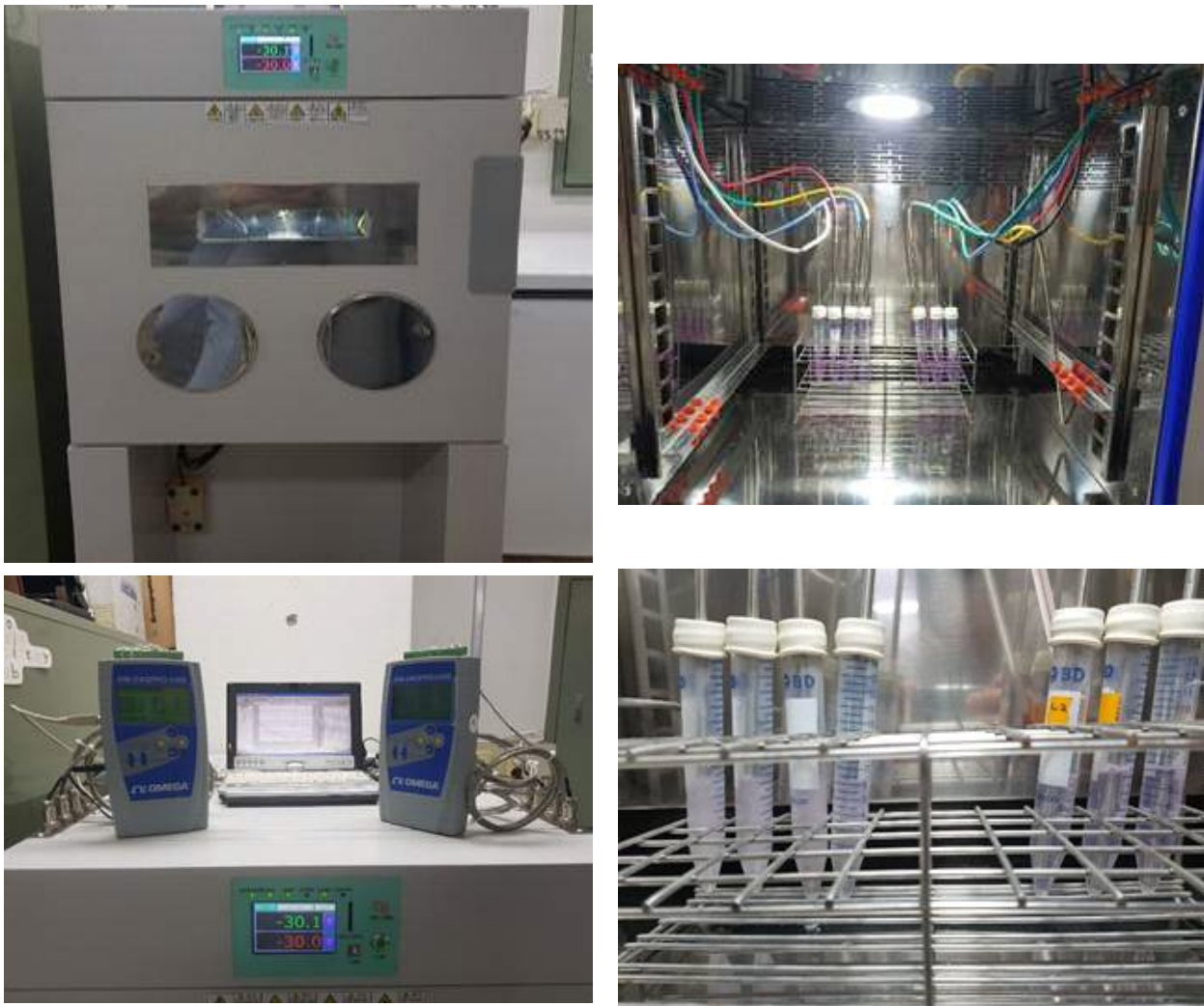
그림 28. 본 과제를 통하여 개발된 장갑형 냉동고(glove freezer)
