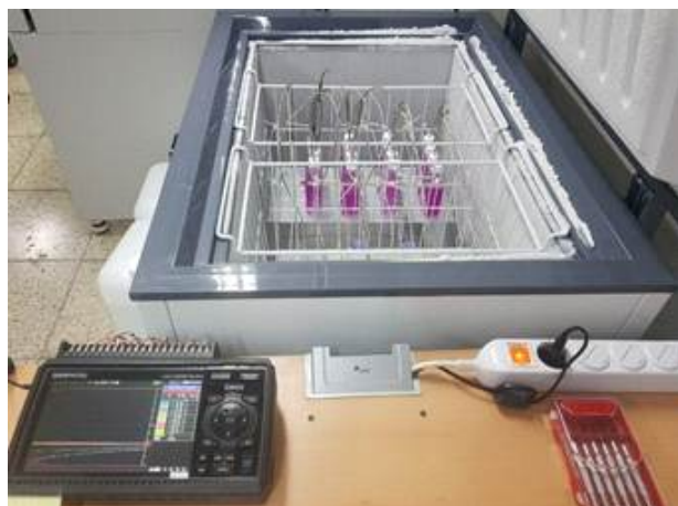
그림 5. 부동 희석액 동결온도 측정 장비
