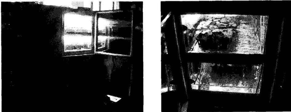
그림 2-1. 온도와 일장 조절이 가능한 생육상의 외부(왼쪽), 내부 전경
