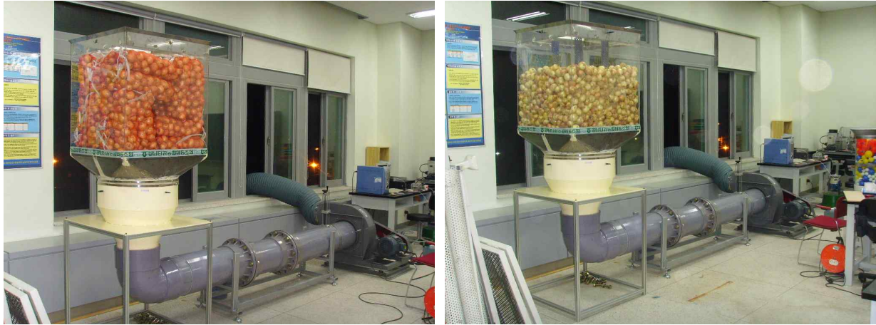
(a) 그물망포장 단위 적재 (b) 통기파이프를 갖는 산물적재 그림 3.12 파렛트에 양과 적재형태별 송풍성 시험광경.
