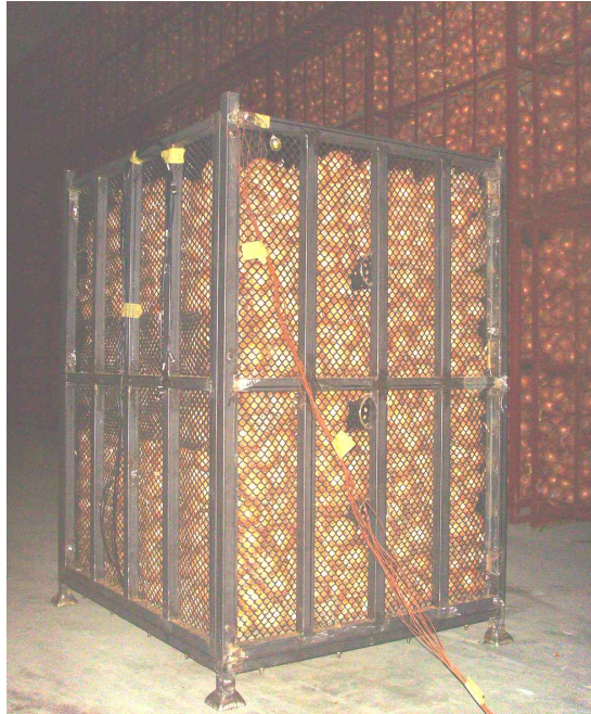
그림 3.25 적재된 양파층 사이의 공기온도측정 실험 광경.
