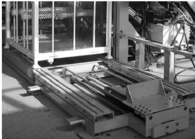
그림 3.49 1차 설계 제작된 공파렛트 자동공급장치.
