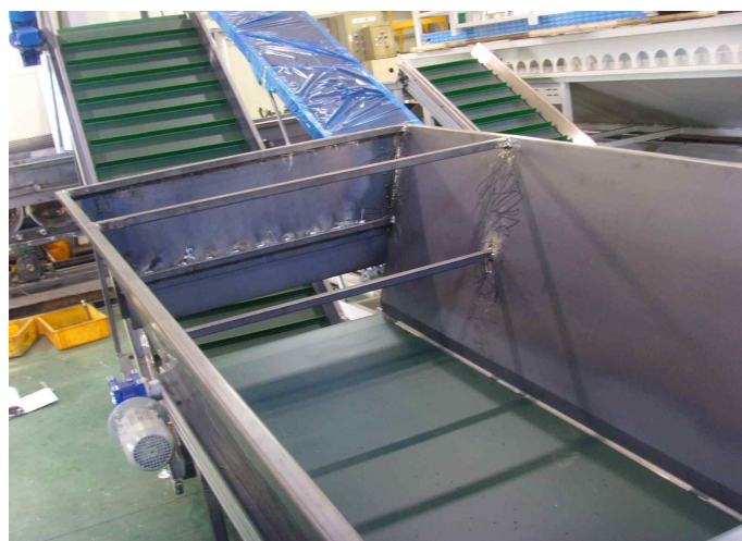
그림 3.42 1차 설계 제작된 양파 임시적재 및 자동공급호퍼.
