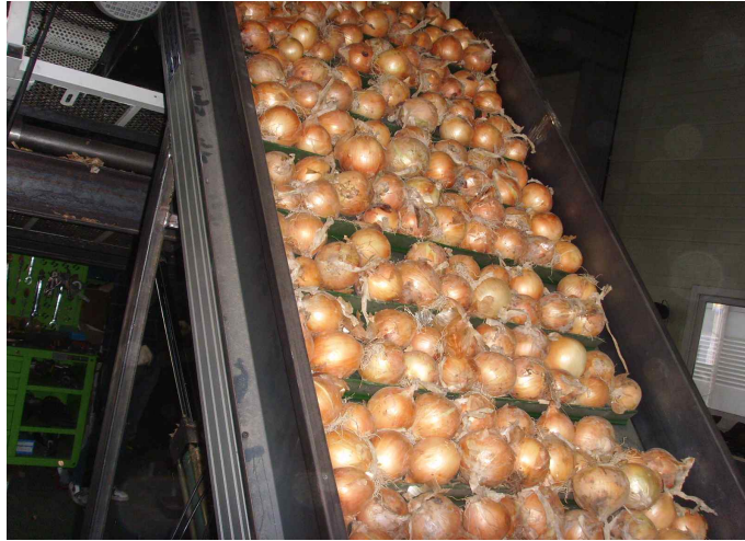
그림 3.44 경사 벨트컨베이어의 설치 각도에 따른 양파의 점유면적 측정실험.
