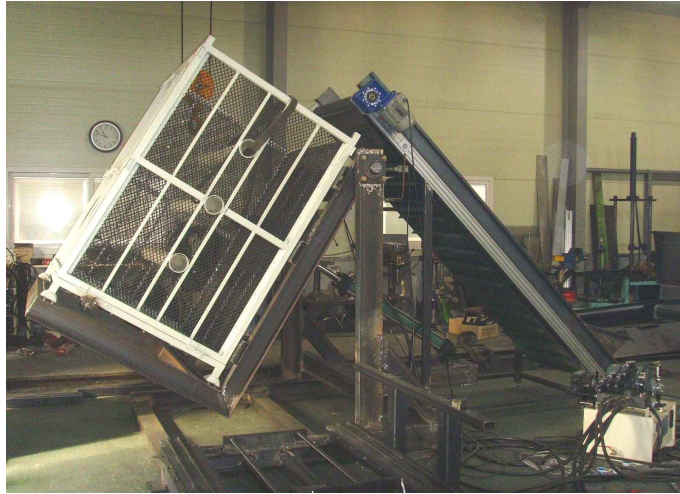
그림 3.39 1차 설계 제작된 auto-dump 장치.
