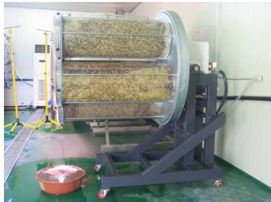
<그림 3-73> 신규 개발된 드럼충진식 새싹생산 기기 시제품
