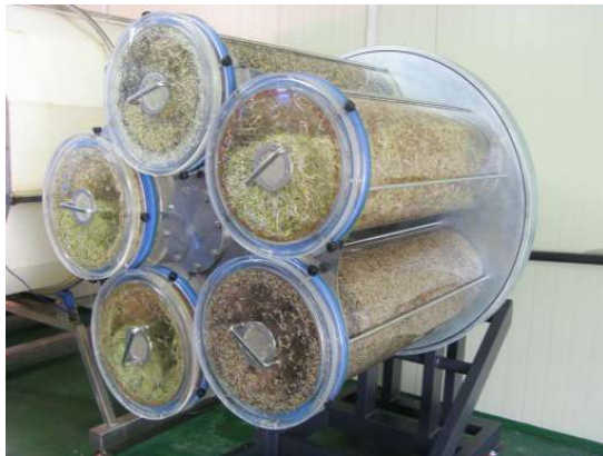
<그림 3-73> 신규 개발된 드럼충진식 새싹생산 기기 시제품
