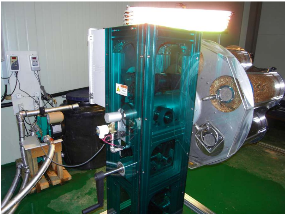
<그림 3-65> 자체 환경조절이 가능한 이동식 경량형 새싹재배기
