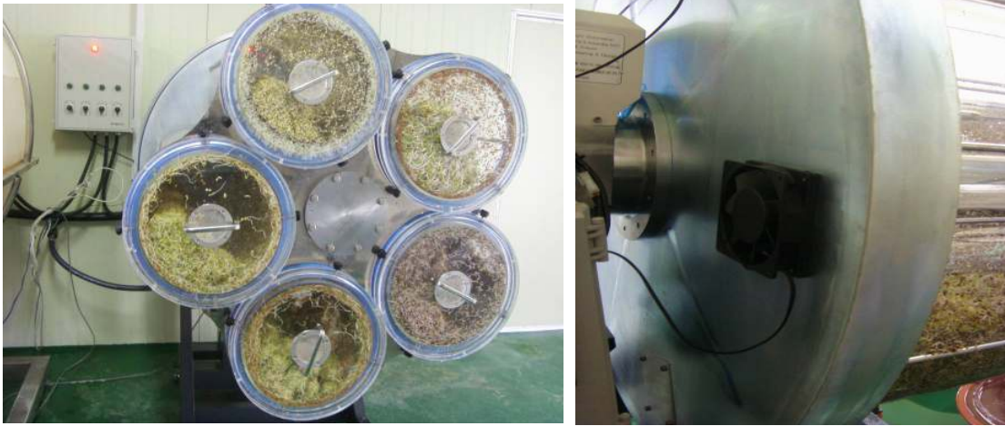
<500L용, 드럼 각각의 흡기구와 별도로 스틸제체의 리어카바 설치>
