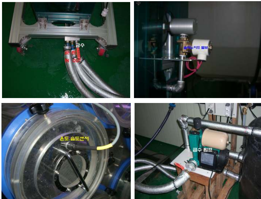
<그림 3-67> 새싹재배기의 습도제어 센서 및 제어시스템
