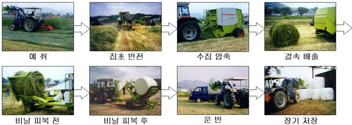
그림 2 국내산 조사료 원형베일 생산시스템
