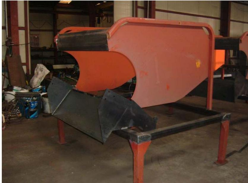
그림 62 지지부 및 프레임 제작사진
