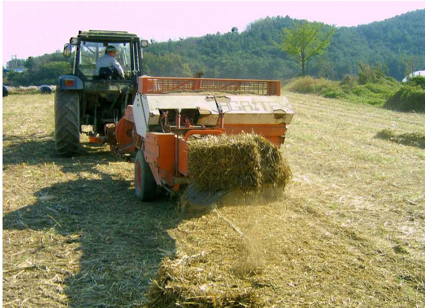
그림 90 사각베일러를 이용한 벼짚의 세절조사료 결속작업
