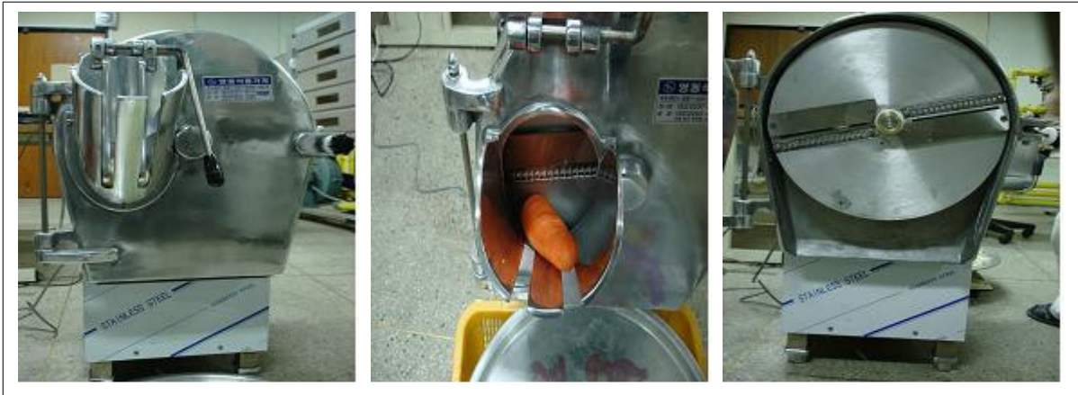
사진 6. 세절장치의 외관 및 칼날 장착
