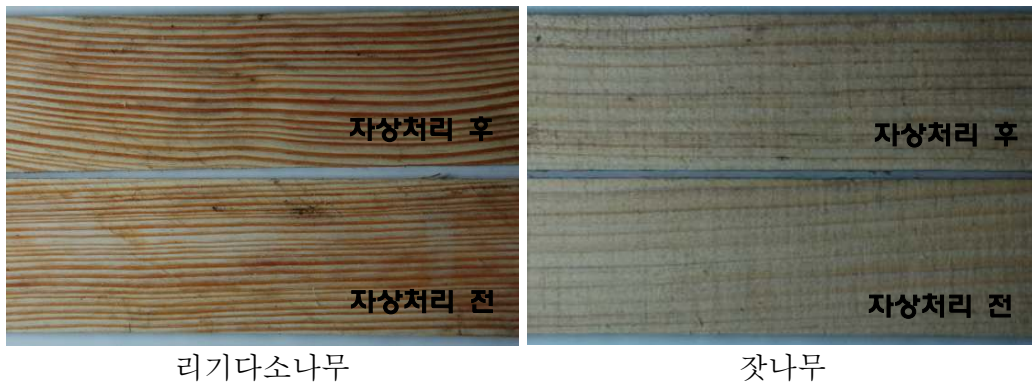
그림 3-4. 자상처리 전후의 재면 상태 (자상 깊이 6mm, 비중 5,000개/m 2 )
