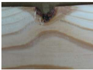
기건 낙엽송 판재 죽은용이의 탈락
