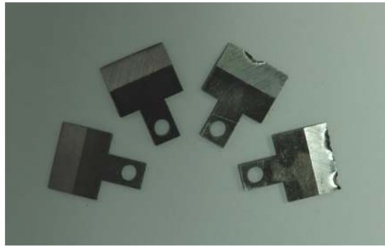
그림 3-6. 낙엽송 판재 자상 처리후의 칼날의 상태 (좌 2개: 진전한 칼날, 우 2개: 손상된 칼날)
