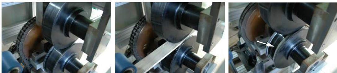
그림 2-12. 횡압축 처리에 의한 리기다소나무 판재로부터 수분의 압출 (좌: 판재 압축 준비, 중: 판재 압축 중, 우: 판재 압축 완료, →: roller표면에서 압출된 백색의 수액 관찰)
