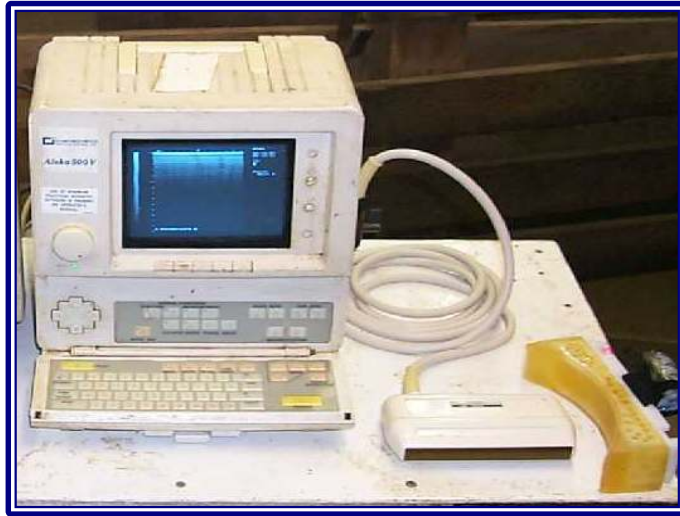
(그림 1) 생돈 마블링스코어 측정용 초음파 기계(모델 : Aloka SSD 500V) 탐촉자 : 3.5MHz, 프로브길이 : 12.5cm
