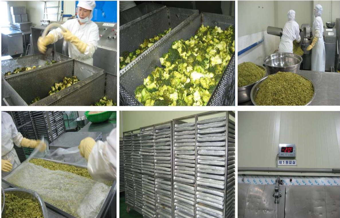
그림 52 . 최적조건 처리된 브로콜리의 동결건조 과정 (세척, coarse grinding, 포장 및 동결 건조)
