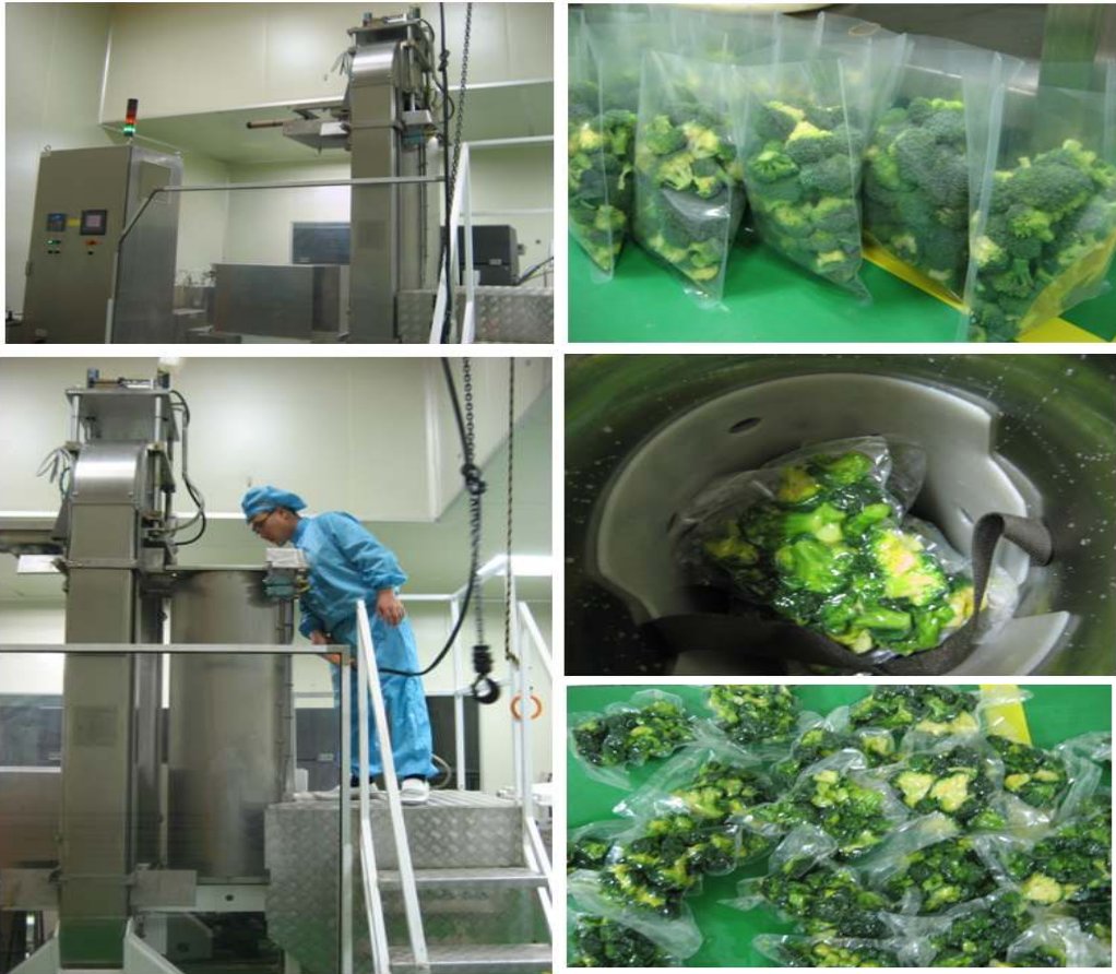
그림 50. 대형 초고압처리기를 이용한 브로콜리 압력처리
