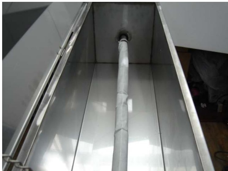
그림3-41 실험실 규모 담액수경 배양액 냉각 시험장치
