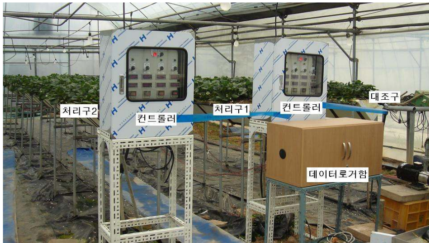
그림3-72 딸기고설수경 재배 배지가온 재배시험 장치
