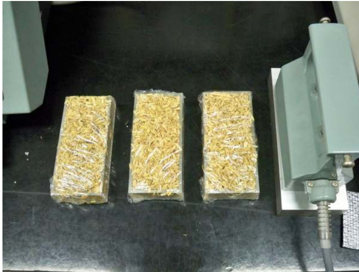
그림 3-2 열전도계수 측정용 배지시료
