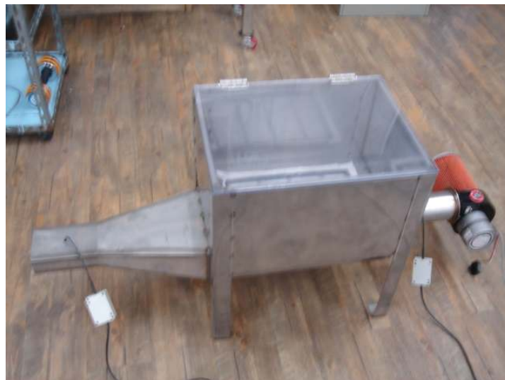
그림3-33 다공질 필름 덕트 증발냉각 특성 시험장치
