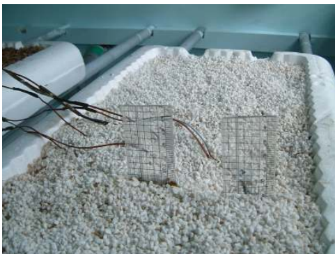
(c) 배지(펄라이트)내 온도센서 설치
