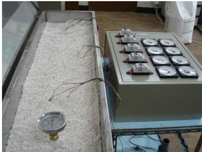
그림3-54 단위 가온튜브의 배지가온 특성 시험장치
