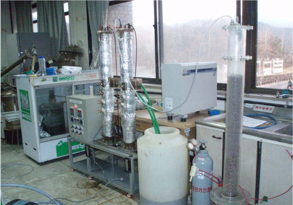
Figure 2-10. 실험실 규모의 ATAD 장치와 Biofilter
