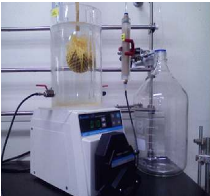
그림 4-2. 단일 현장토착탈질미생물과 CRM (Controlled Release Molasses)을 적용한 1차원 컬럼 사진
