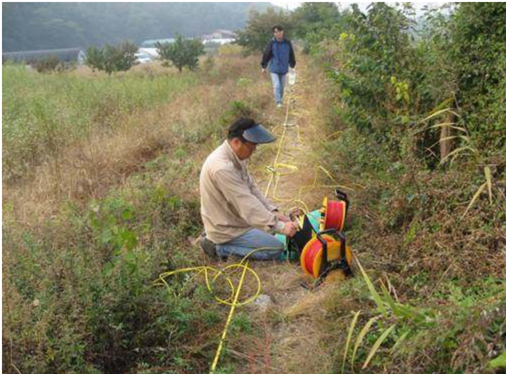
(b) 현장 전기 비저항 탐사 전경
