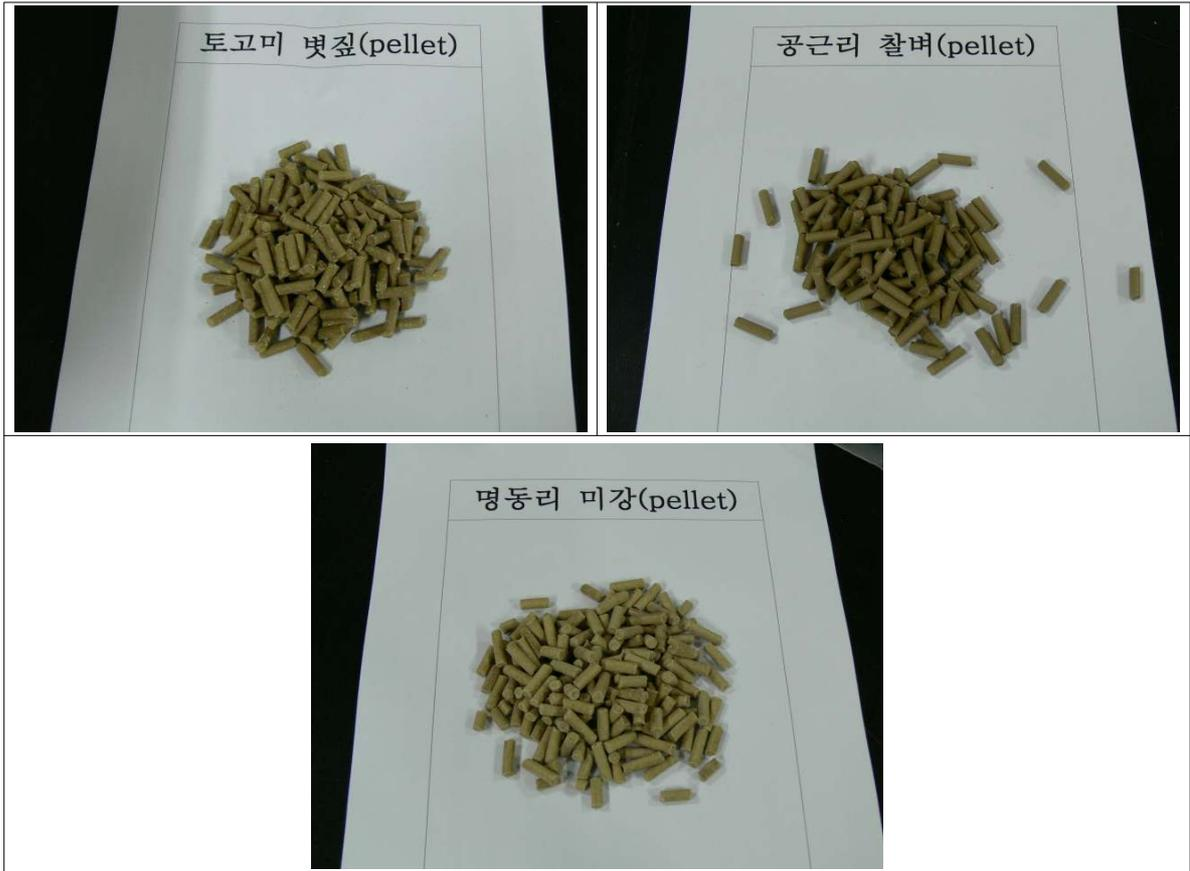
그림 2-4. 토고미 벧짚과 공근리 찰벼 그리고 명동리 미강의 펠렛 성형 사진
