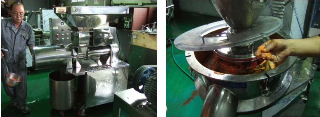
그림 7. 마이크로밀을 이용한 고추 분쇄
