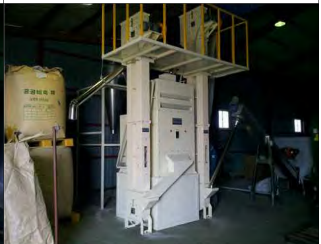
그림 7-59. 녹색WG 원료 정선시스템의 설치된 모습(2)
