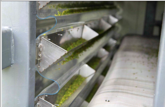
이동순환식건조시스템의 bucket elevator의 녹색곡물 이송 장면
