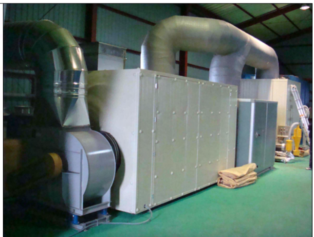
그림 7-36. 열교환방식 녹색 WG 건조장치 현장 설치
