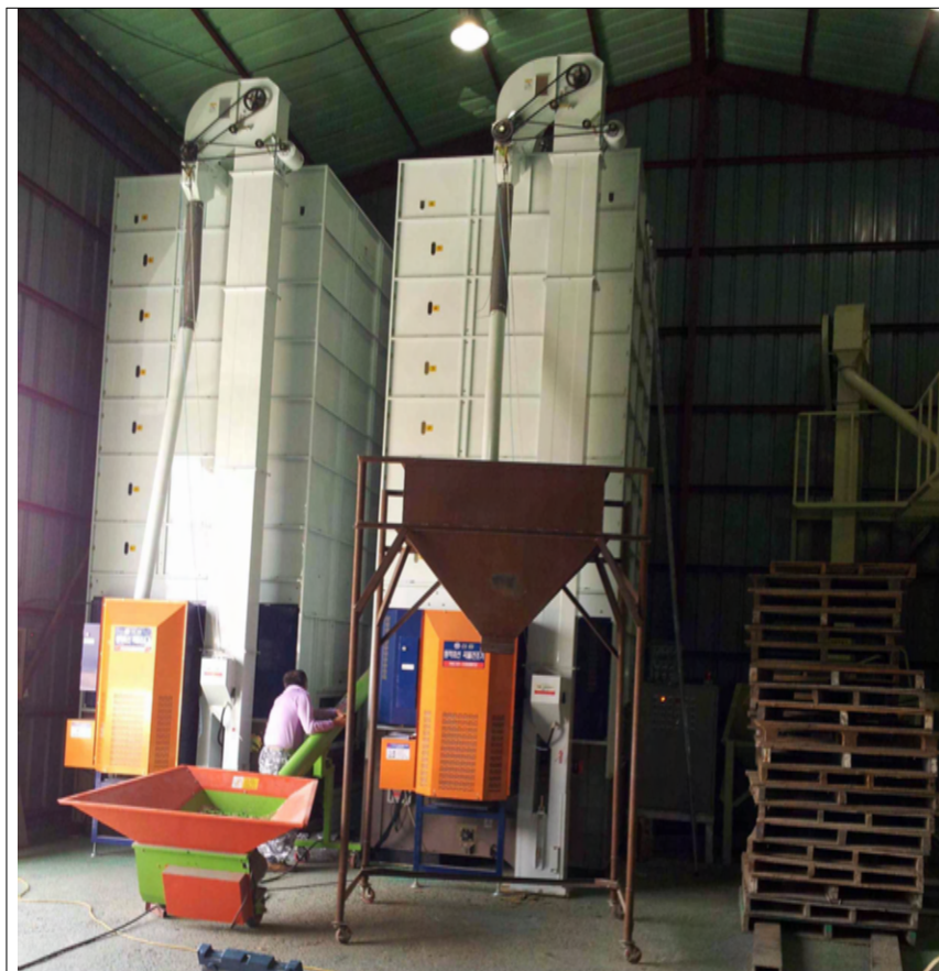
그림 7-44. 녹색통곡미 원료의 2차 건조를 위한 순환식 건조시스템의 설치된 모습
