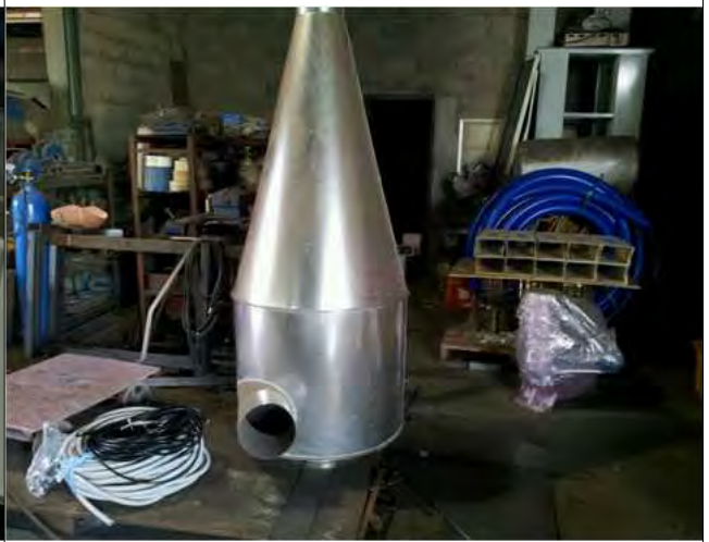
그림 7-49. 녹색WG 원료 정선시스템의 사이클론 설치 전 모습
