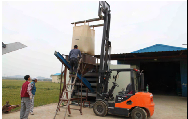
이동순환식건조시스템의 투입구를 이용한 녹색WG 투입작업 장면
