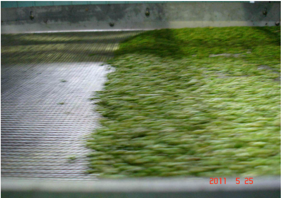
그림 13. 이송 Conveyor위에서 Blanching 시스템 챔버내부로 이송되는 곡물
