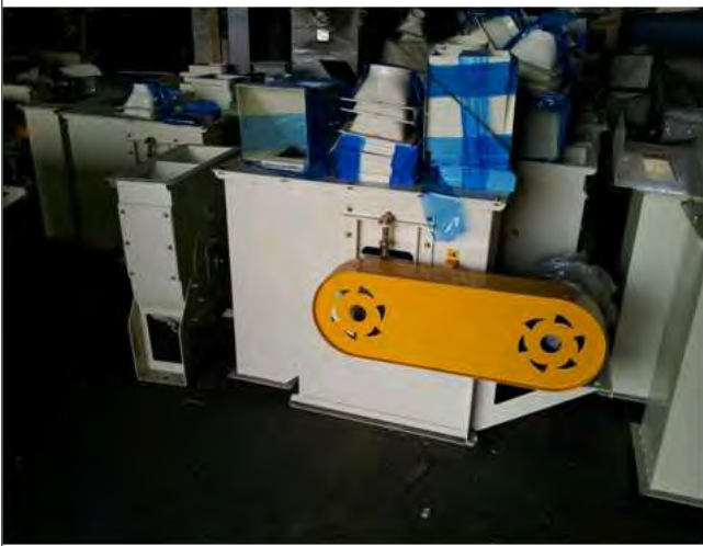
그림 7-48. 녹색WG 원료 정선시스템의 bucket elevator 설치 전 모습
