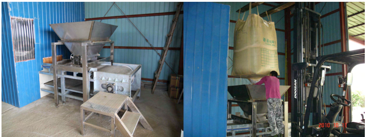
그림 5. 블랜칭 시스템 투입부 및 투입부에 곡물투입 장면
