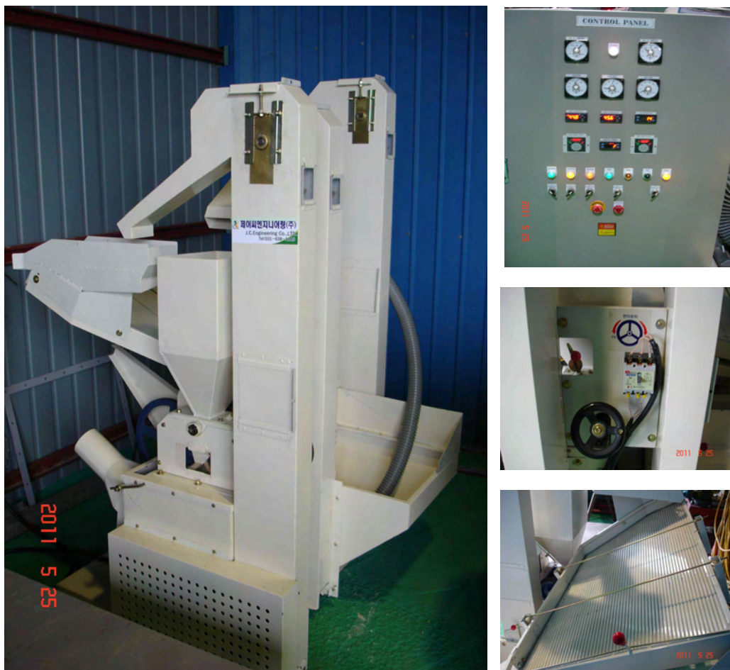
그림 17. 블랜칭 후 건조 곡물 탈부시스템(좌), 제어부, 조절장치, 정선부
