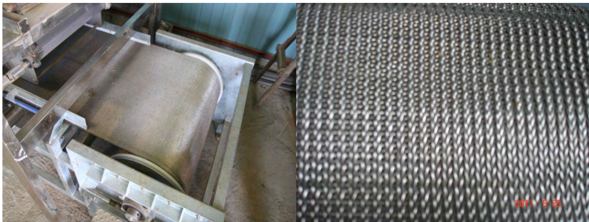
그림 8. 블랜칭시스템의 순환식 conveyor 구동부와 Wire mesh(1,000 × 20,700mm)
