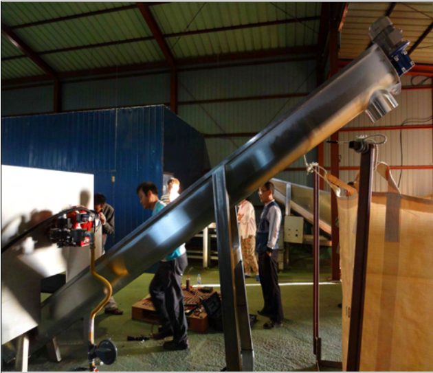
그림 7-42. 회전식강제온풍송풍건조시스템 하단의 녹색WG원료 이송 오거
