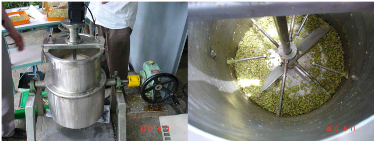
그림 16. 건조하지 않은 쌀보리의 탈부특성 측정을 위한 기초실험 장치 제작 실험
