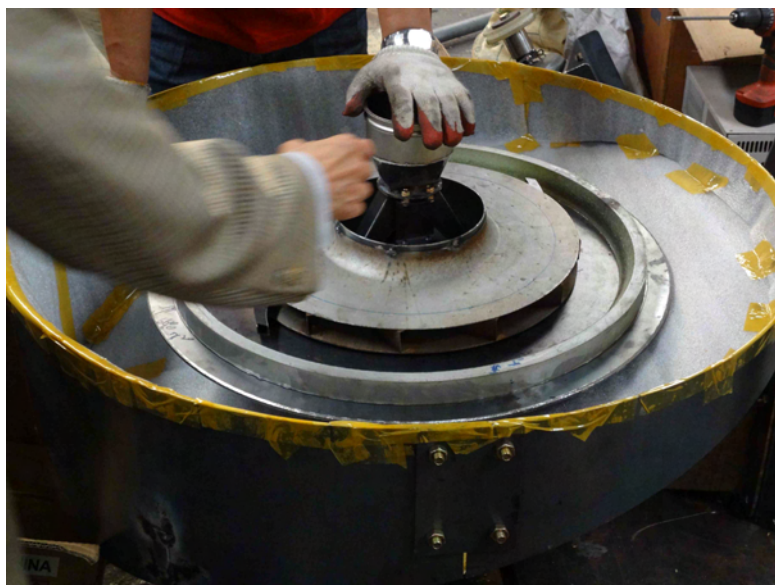
그림 15. 건조하지 않은 곡물(쌀보리)의 탈부가능성 실험을 위한 충격식 탈부장치
