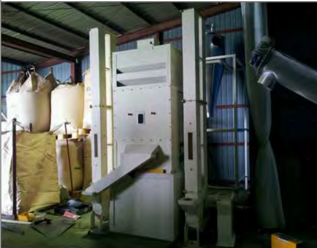
그림 7-56. 녹색WG 원료 정선시스템의 원료정선기 및 승강기 설치 모습
