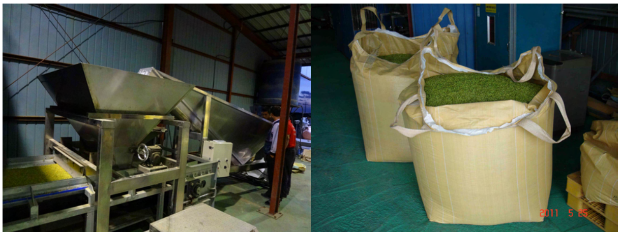
그림 6. 녹색곡물 투입작업 개선을 위한 자동 투입장치 제작 부착
