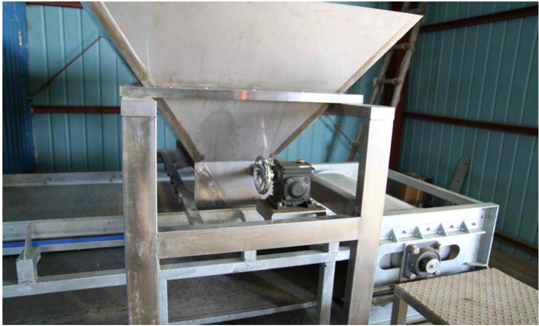
그림 4. 블랜칭 시스템 투입부의 곡물이송장치
