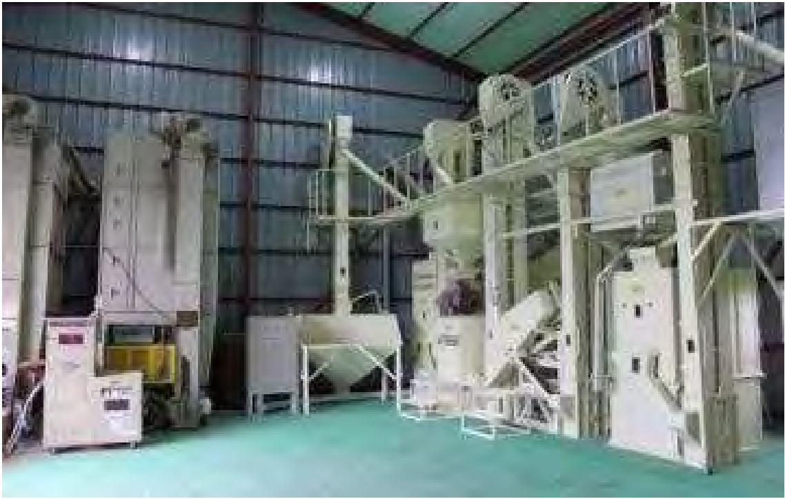
그림 1-6. 건조기 및 정선기(군산시 대야면 설치)
