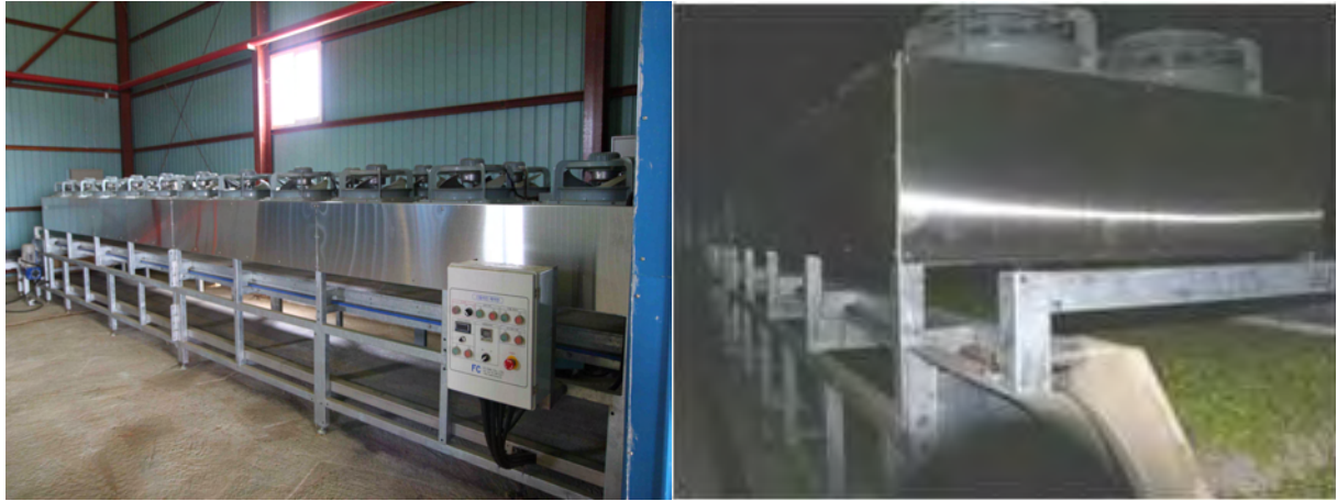
그림 9. 블랜칭시스템의 제습 냉각-제습 터널
