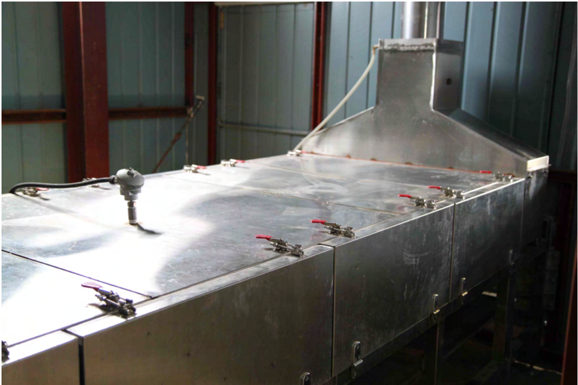
그림 12. Blanching 온도 조절을 위한 온도센서가 부착된 Blanching부
