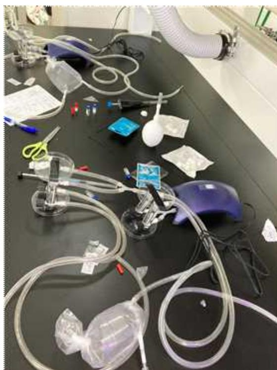
그림 43. 해충방제학 실험실에서 제작한 portable volatile collection system (PVCS) 프로토타입으로 volatile profiling 을 하고 있는 모습
