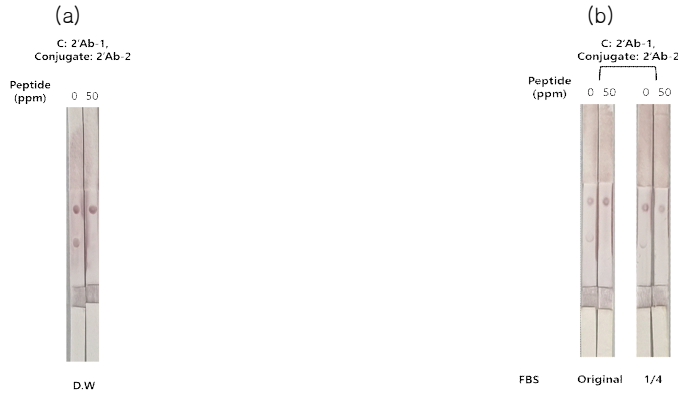
그림 58. 브루셀라균 대사체 peptide 신속 검출을 위한 항원별 LFA 법 시료 적용 결과. 전개용매: 증류수(a), FBS(b), C: control, Conjugate: conjugate pad, 2'Ab-1: Goat anti-mouse IgG, 2'Ab-2: Rabbit anti-mouse IgG
