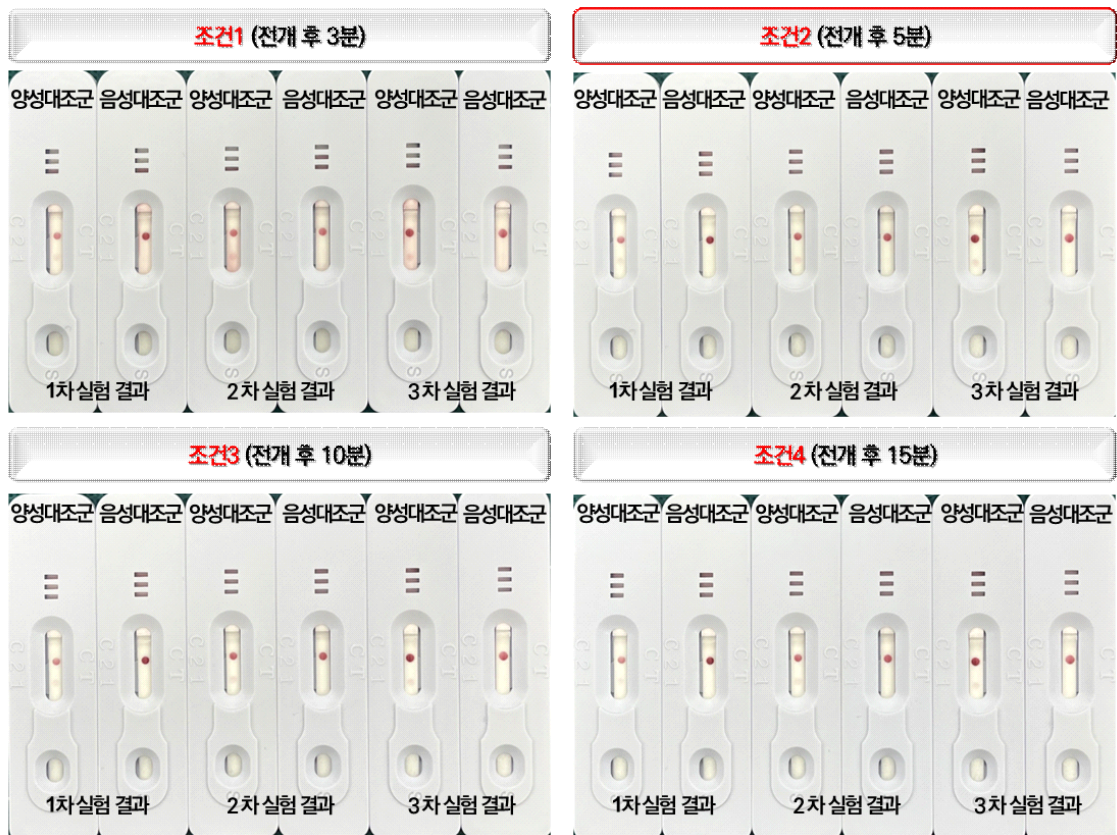
그림 82. 측방유동스트립의 최적 반응종결시점 선정을 위한 실험 결과
