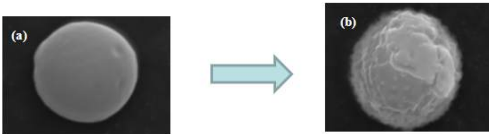
그림. 11. SiO 2 의 Scanning Electron Microscope(SEM) 사진 (a) 무코팅 SiO 2 (b) SiO 2 코팅 키토산 입자. (cross-linking agent: glutaraldehyde)
