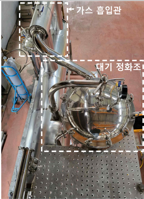
대기 정화조(상부 덮개)
