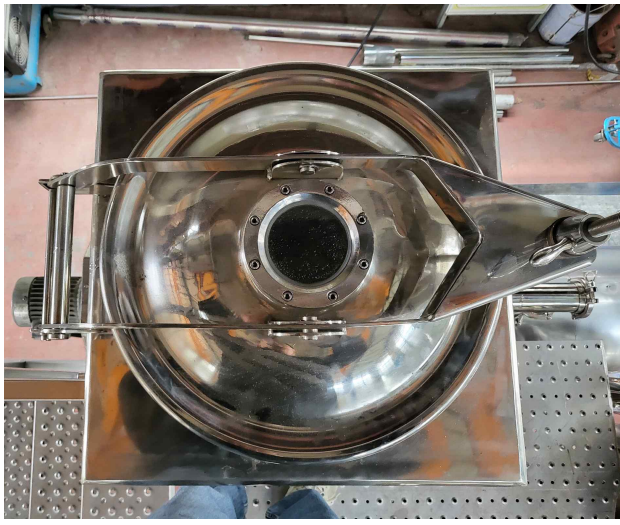
원료 공급 호퍼(상부 덮개)
