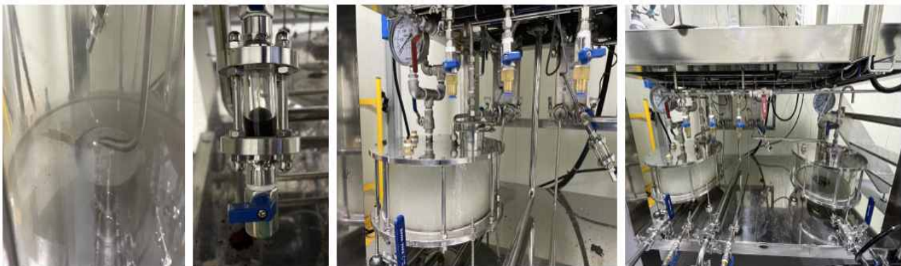
Fig. 78. 가축사체 전용 biochar 제조장치에서 오일의 추출과 가스의 포집.
