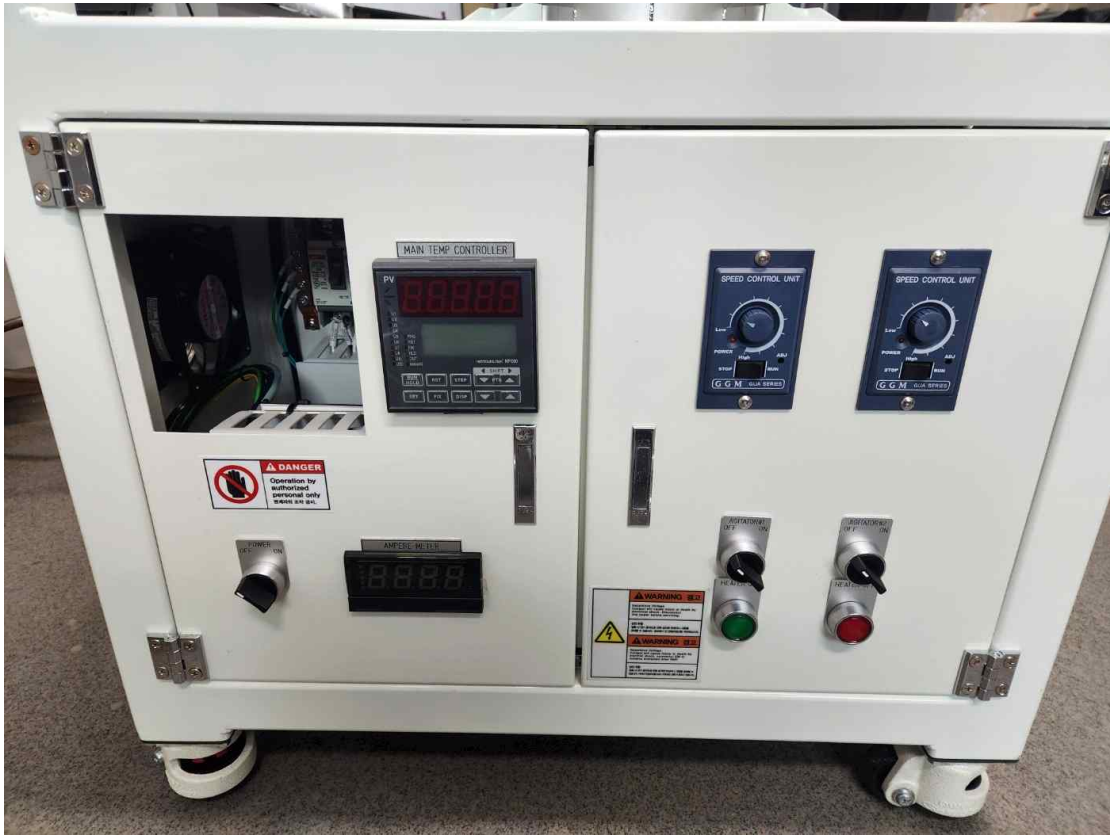
Fig. 90. 제작된 랜더링 가속사체 아미노산 액비 제조장치의 외부 컨트롤러.
