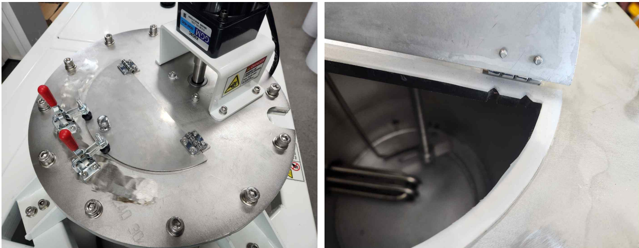
Fig. 91. 제작된 랜더링 가속사체 아미노산 액비 제조장치의 반응조 공급부.
