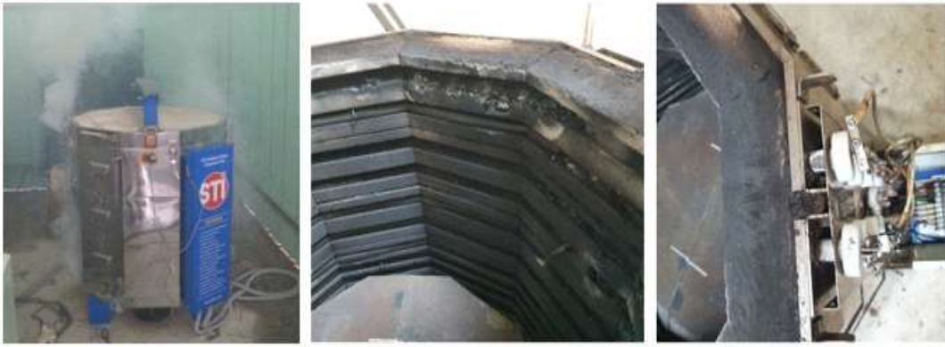
Fig. 60. Biochar 제조 과정에서 발생하는 syngas 및 가스체류로 인한 열선손상/콘트롤러 손상.
