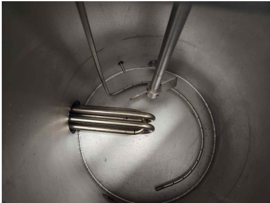
Fig. 89. 제작된 랜더링 가속사체 아미노산 액비 제조장치의 반응조 내부.
