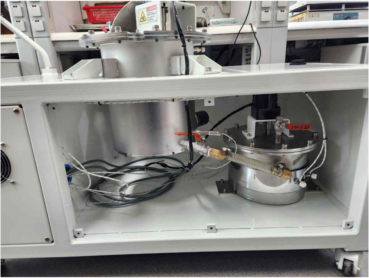
Fig. 92. 제작된 랜더링 가축사체 아미노산 액비 제조장치의 반응조 및 농축조.
