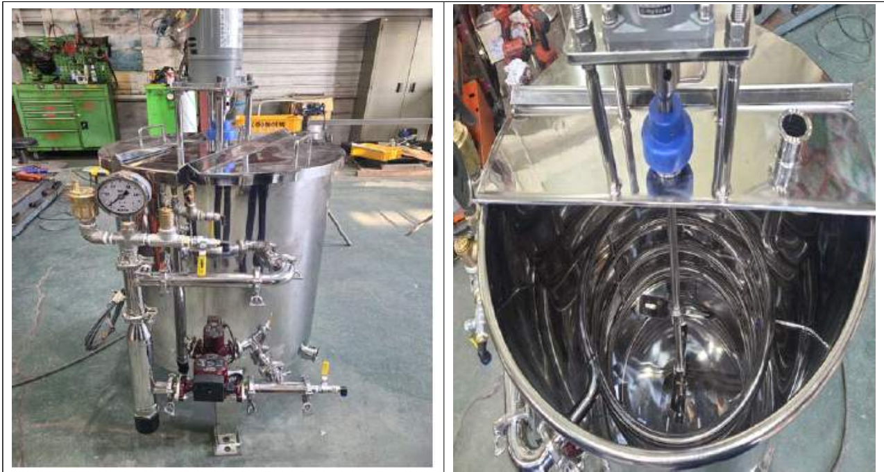
Fig. 175. 현장에 설치된 랜더링 가축사체 전용 아미노산 액비 제조장치.
