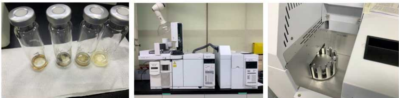
Fig. 5. 오일 성분 분석에 사용된 샘플과 GC-MS의 장비.
