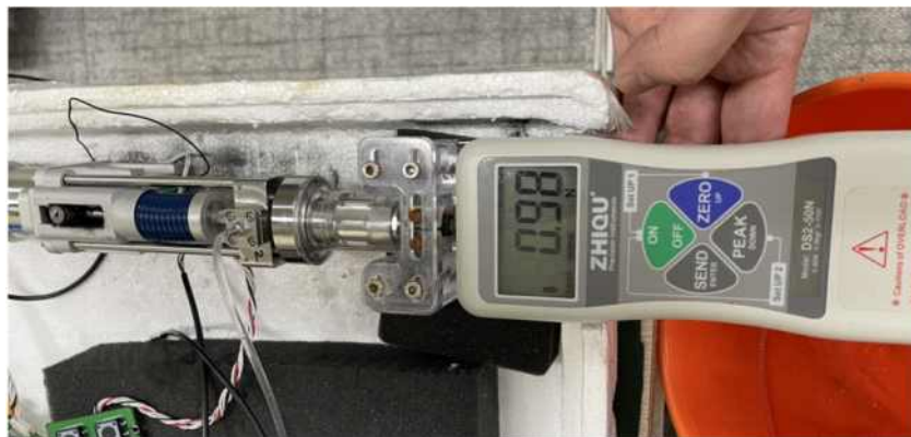
그림 40. 배터리 전압별 토출압력 시험
