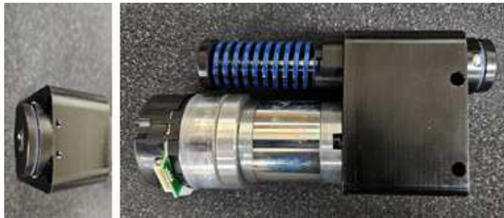
그림 46. 핵심 모듈. (a) Nozzle Part, (b) Cylinder Part
