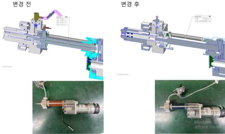
그림 30. 토출압력 변경을 위한 스프링 및 내부 구조 변경
