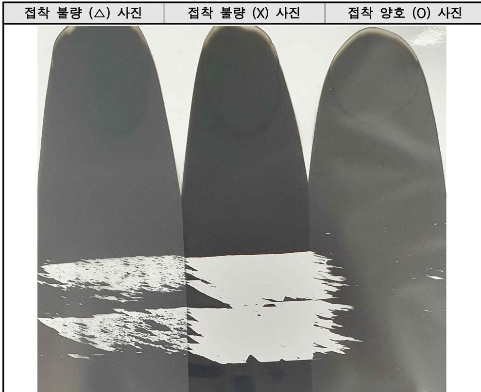
사진. Film 표면 Ink 접착 Test 비교 사진
