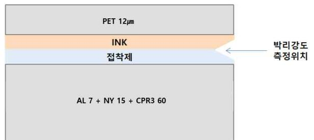
사진. 잉크 박리강도 측정 사진
