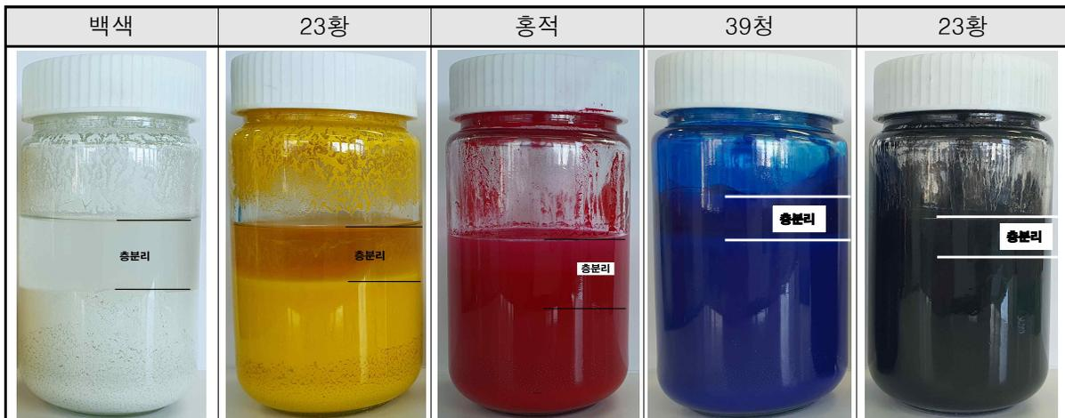
사진. Ink 층분리 발생 사진 - 제품화 불가
