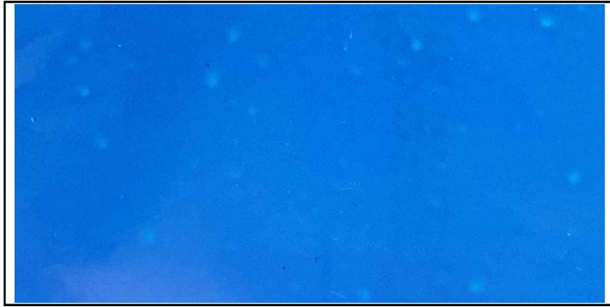
사진. Coating면 Pin Hole 현상 발생
