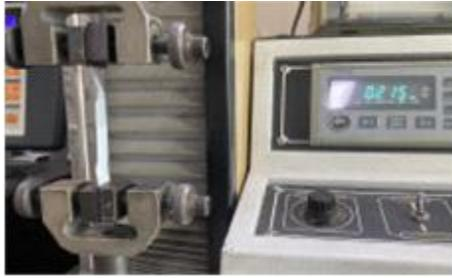
그림. 잉크 박리강도 측정 사진
