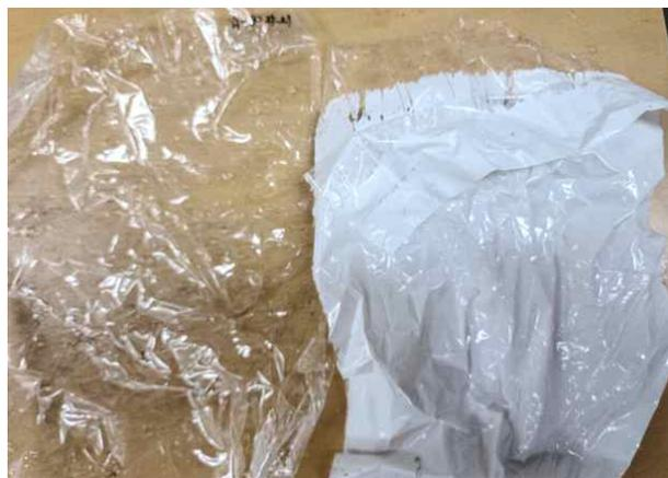
사진. 120°C에서 테스트 된 시편필름- 왼쪽: A-90#21 단독, 오른쪽: 백색잉크
