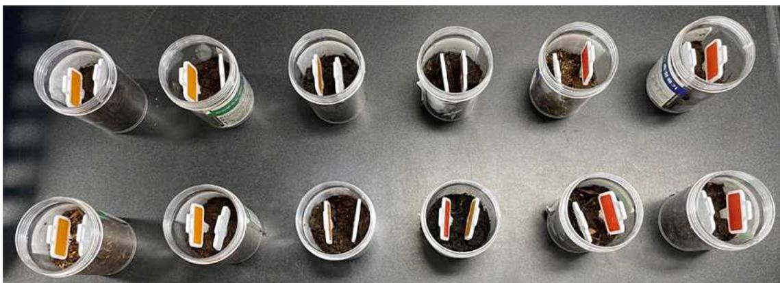
Fig. 2-11. 솔비타법을 이용한 부숙도 시험.
