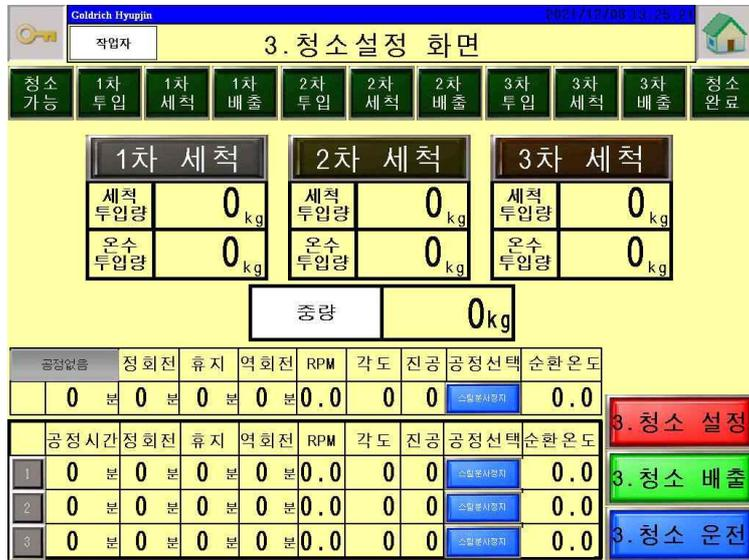
그림84. 자동세척 시스템 컨트롤화면
