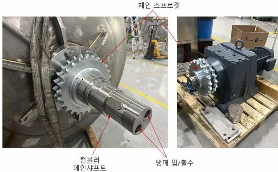
그림82. 텀블러 회전 드라이빙 시스템
