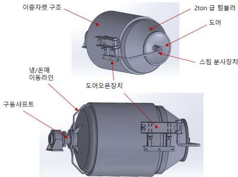
그림14. 2000L급 해동 텀블러 3D 모델 및 주요 파트
