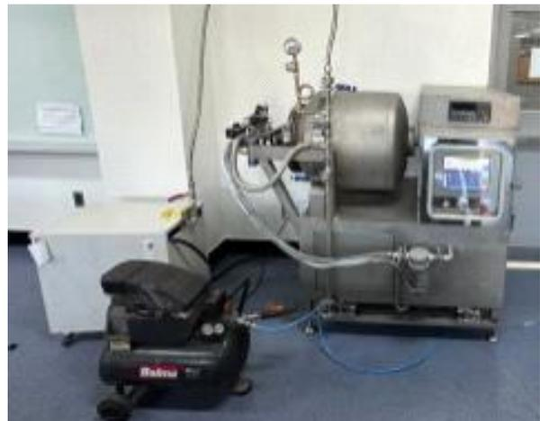
그림107. 탱크 내 임펠러와 100L-scale 텀블링 해동 장치
