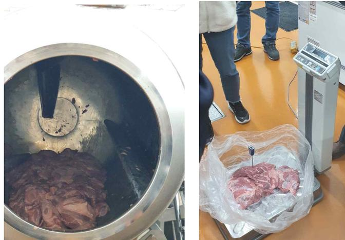
그림63. Pilot-scale 텀블러 해동과정(좌)과 해동 후 심부온도 및 무게 측정(우)
