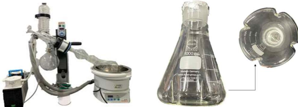
그림59. 텀블링 해동을 위한 구성 장치(좌)와 진탕 삼각플라스크(우)
