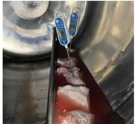
그림109. 텀블링 회전가속에 따른 육 조직파괴 및 과량의 스팀에 따른 해동 후 텀블러 내 물고임 현상
