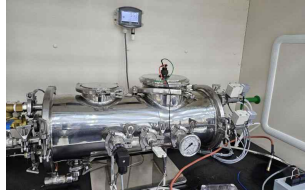
<CO 2 센서 시험 장비(가스공급 스위칭 모듈)>
