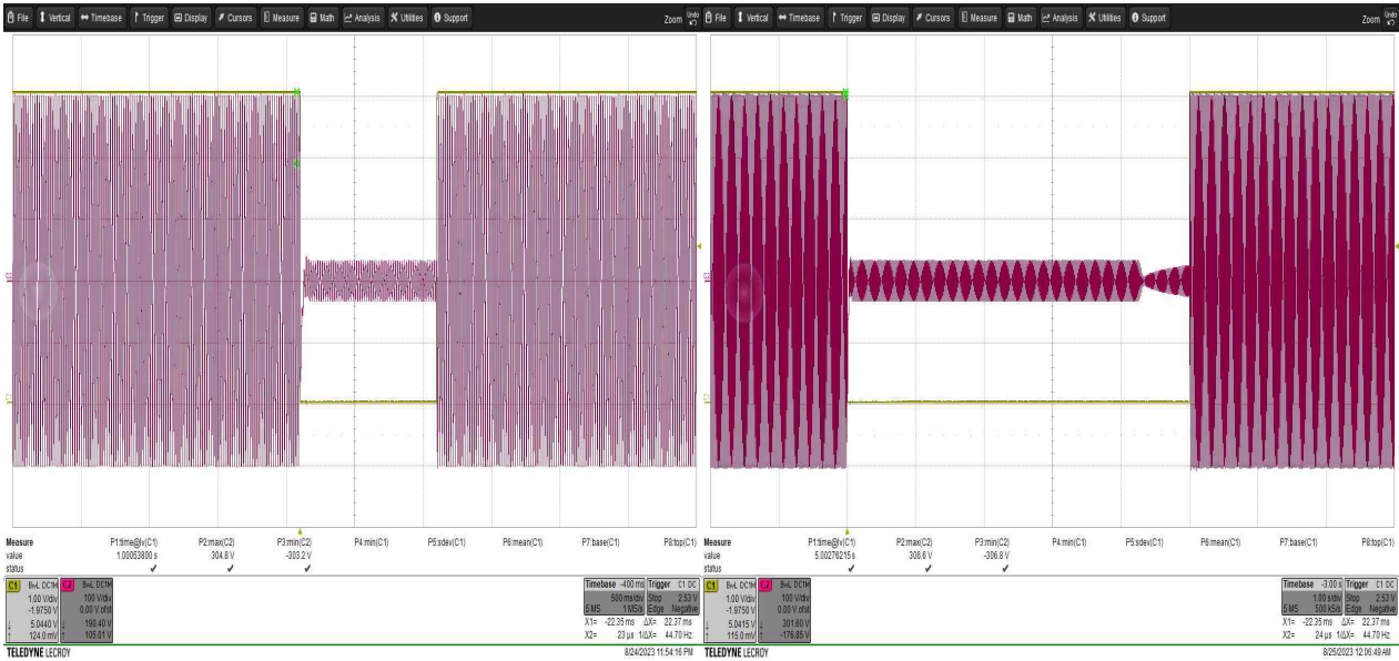
<정전센서 BlackOut Test 1s, 5s>
