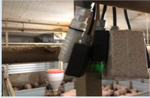
축사 내부 - 센서 6종 필터 상태 점검
