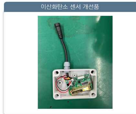
- KS X 3279 내기센서:이산화탄소 측정범위 규격에 맞게 0~10000ppm 센서로 변경
