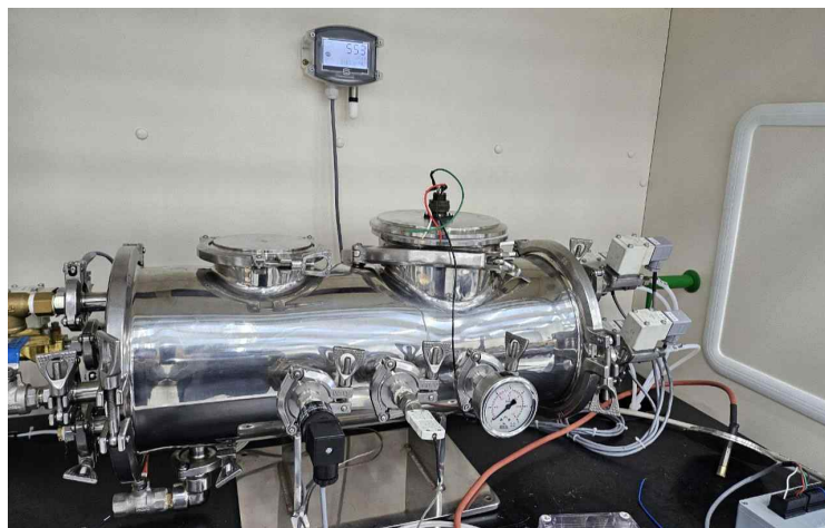
<CO 2 센서 시험 장비(가스공급 스위칭 모듈)>
