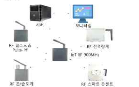
그림 1 스마트팜 에너지 모니터링 시스템 구성도
