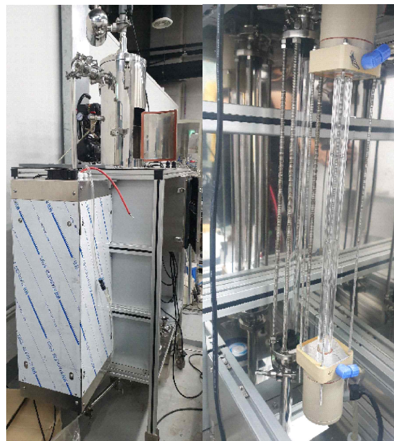
그림 12. 광펄스 램프 배관 외벽이동 설치 제작
