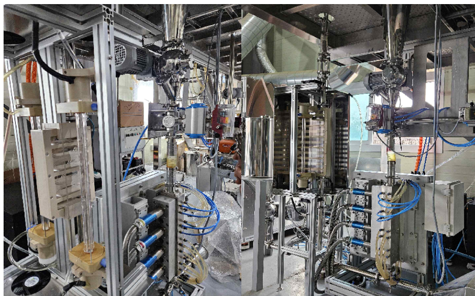
그림 33. 광펄스 램프 설치용 S곡관 짧은 것(ver C) & 긴 것(ver C+) 구조물
