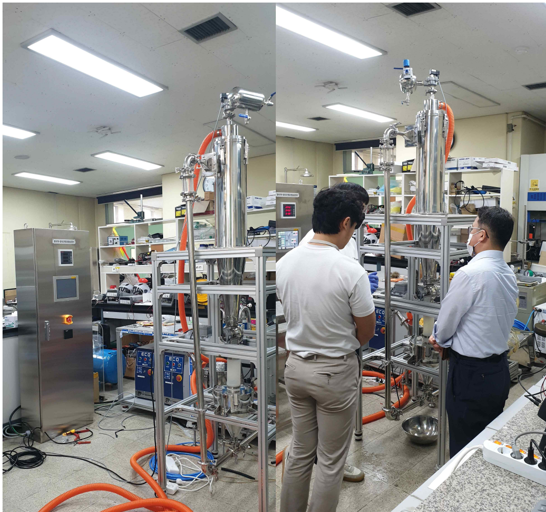
그림 14. 콜드플라즈마 장비 + 음이온 발생장치 병합 살균 장비 서울과학기술대학교 설치
