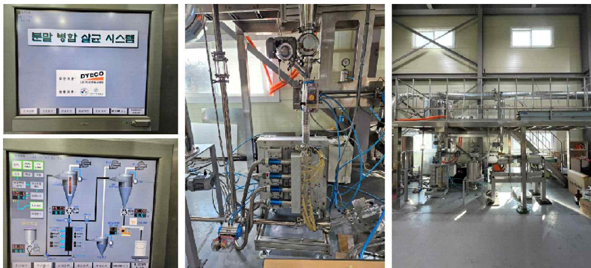
그림 98. 대용량 분말 병합 살균 시스템.
