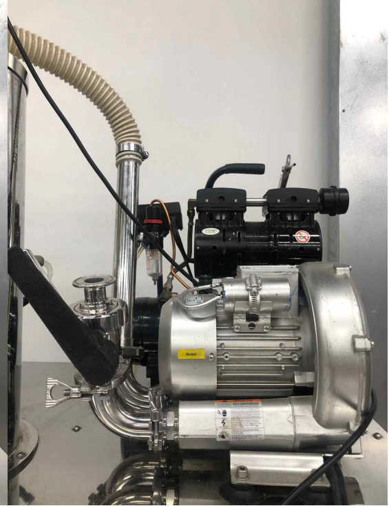
그림 43. 배기구 조절 밸브를 설치한 Blower 형태 (experimental)
