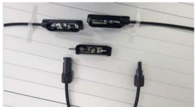
< 루프탑 투광형 양면형 태양광 모듈 제작용 Junction box >
