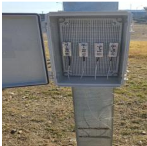
<자기 희생 전극을 활용한 영농형 태양광 구조물의 내부식성 향상 결과 예시>
