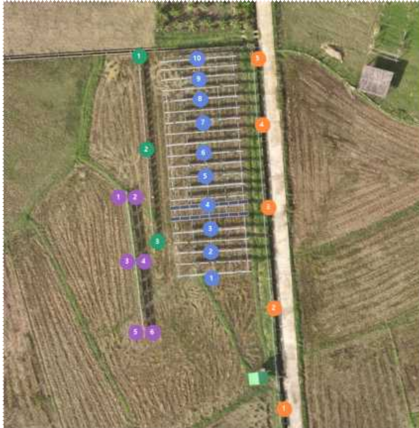
< 무음영 영농형 태양광 발전 설비의 구조별 음영 측정 포인트 >
