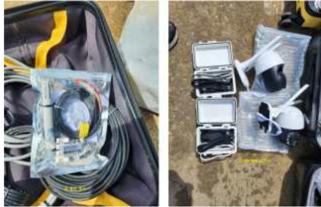
< 60kW급 무음영 영농형 태양광 발전 실증 설비 모니터링 센서 >
