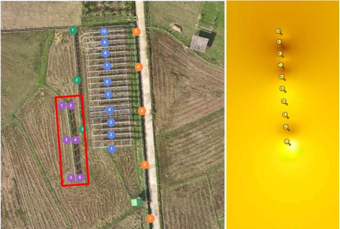
< 펜스형 2단 태양광 모듈 음영 측정 point(좌) 및 음영 지수(우) >
