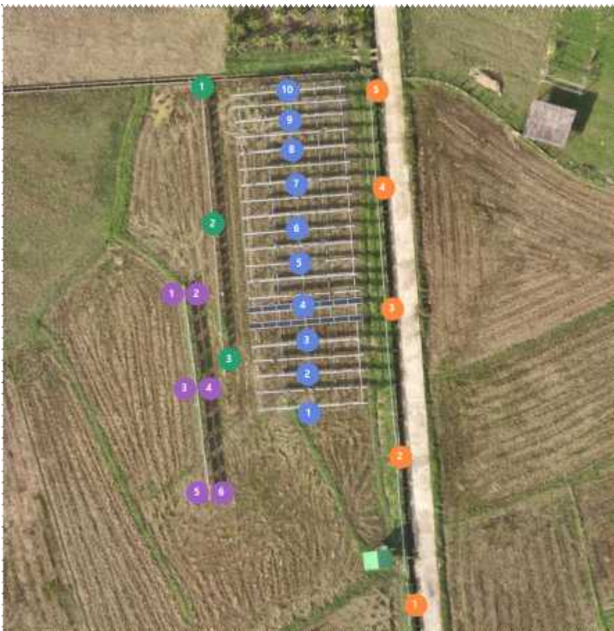
< 무음영 영농형 태양광 발전 설비의 구조별 음영 측정 포인트 >
