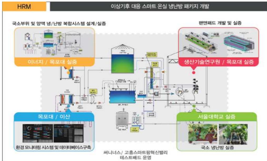
그림 1. 온실 하이브리드 냉난방 모듈과 시스템 개념도
