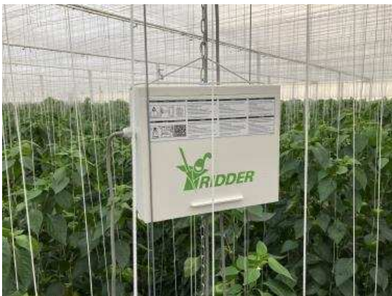
그림 9-6. 온실 내부 온습도 측정센서
