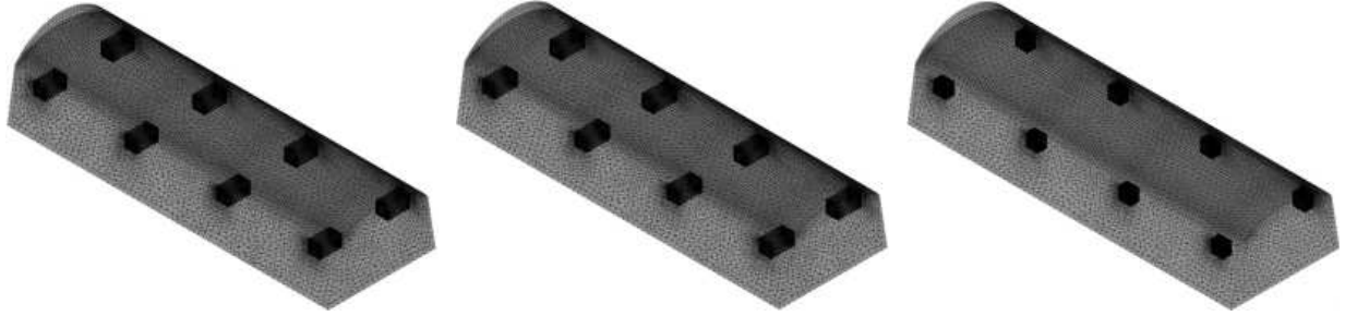
(a) 강제 냉각 격자 (b) 증발 냉각 격자 (c) 강제 난방 격자 그림 6-45. Multi channel hybrid H/X PAD 열유동 해석 격자생성
