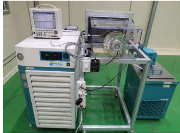
그림 6-37. 초친수 냉각 PAD 적용 Hybrid H/X module 성능실험 장치 모델링 및 사진
