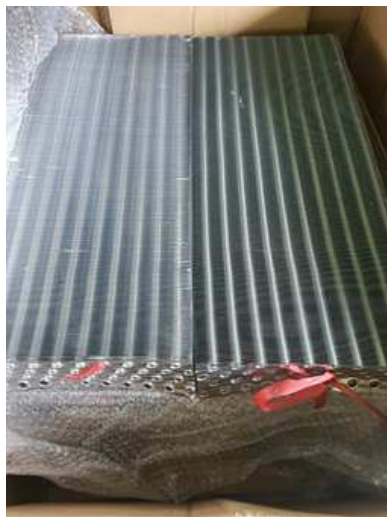
그림 6-26. Hybrid 냉각 PAD용 AL Fin 적층 사진
