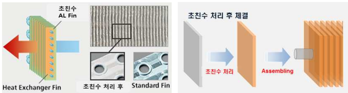
그림6-50. 초친수 Al Fin 제작 및 조립 공정
