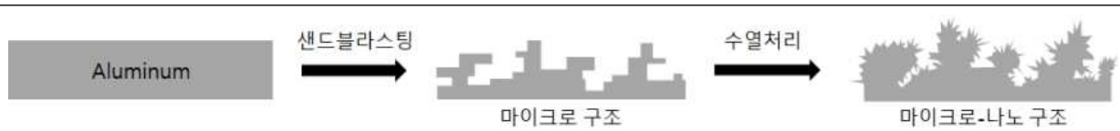
그림 6-1. 초친수 러프니스 구조 형성 모식도
