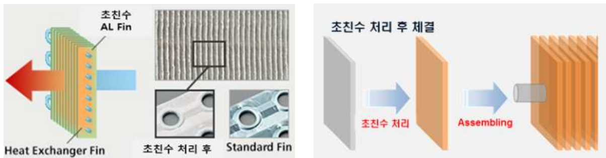
그림 6-29. 초친수 AL Fin 제작 및 조립
