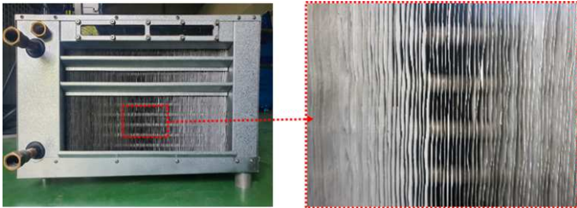
그림 6-34. 초친수 냉각 PAD 적용 Hybrid H/X module 사진 및 AL Fin 형상
