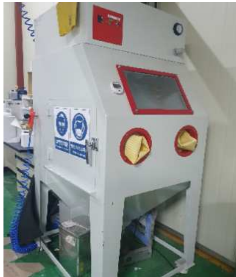
그림 6-22. AL Fin 1차 표면 거칠기 가공용 Sand blaster
