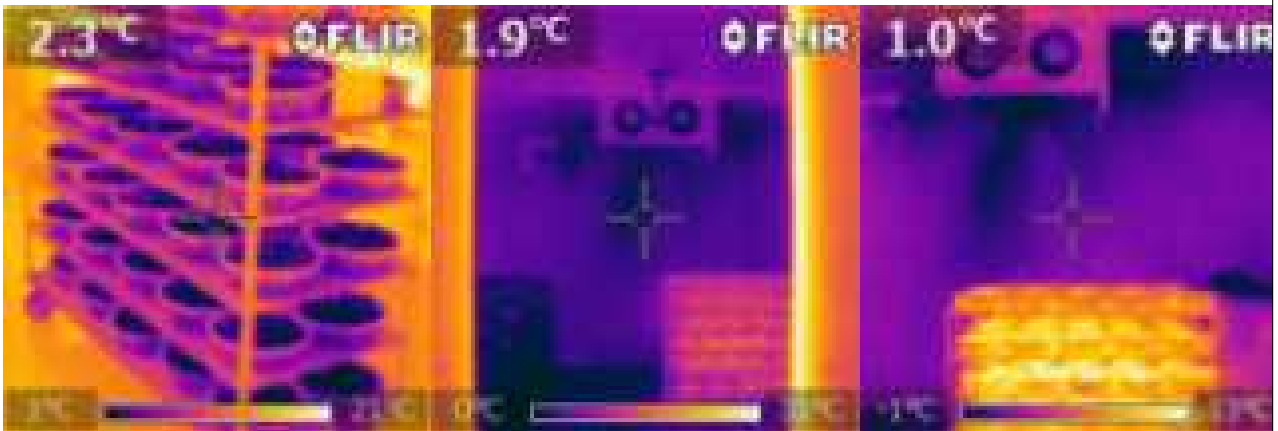
그림 68. 진주 수곡의 딸기 예냉시설의 열화상기로 측정한 온도 현황
