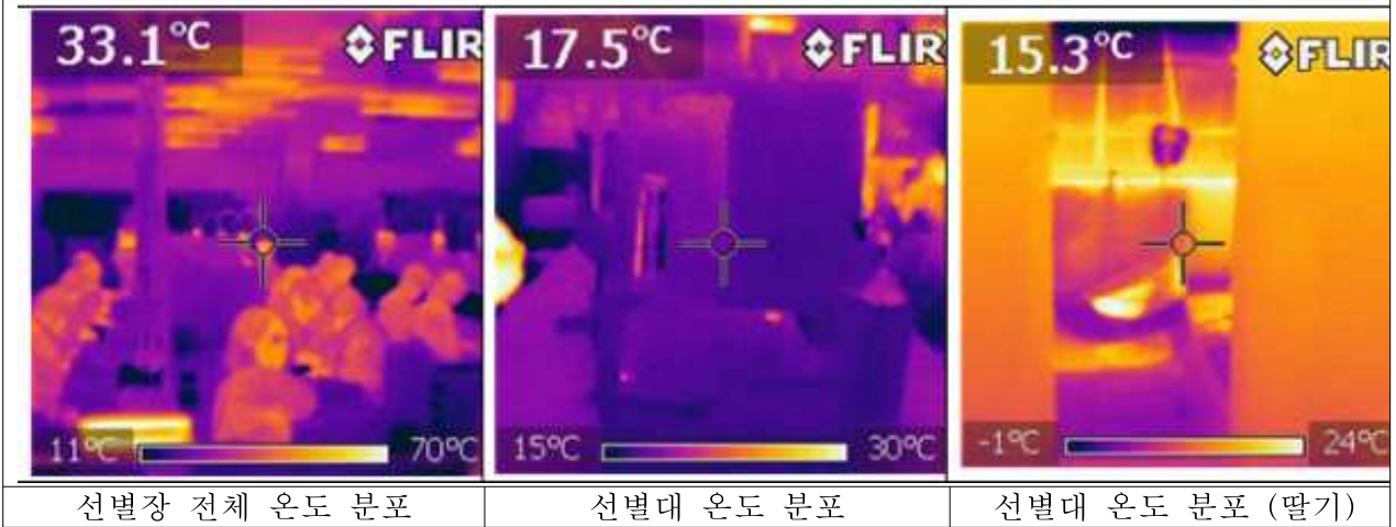
그림48. 열화상기로 조사한 선별장의 전체온도와 선별대 온도 분포
