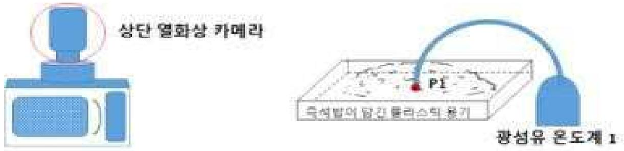
그림 128. 전자레인지 온도 분포 측정 부위 및 광섬유 온도계 측정 부위
