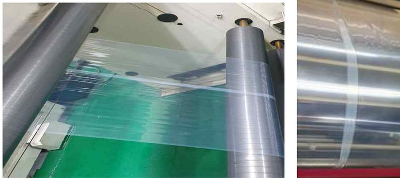
그림 16. 내열 PE 라인테스트 열 변형 현상
