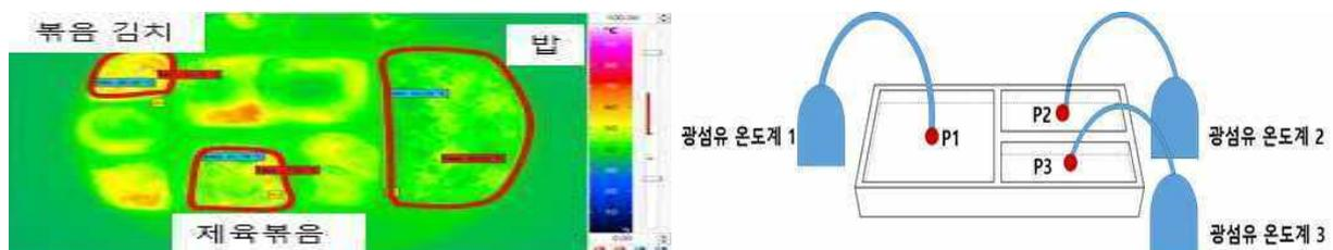
그림 110. 냉장 도시락 전자레인지 온도 분포 측정 부위 및 광섬유 온도계 측정 부위
