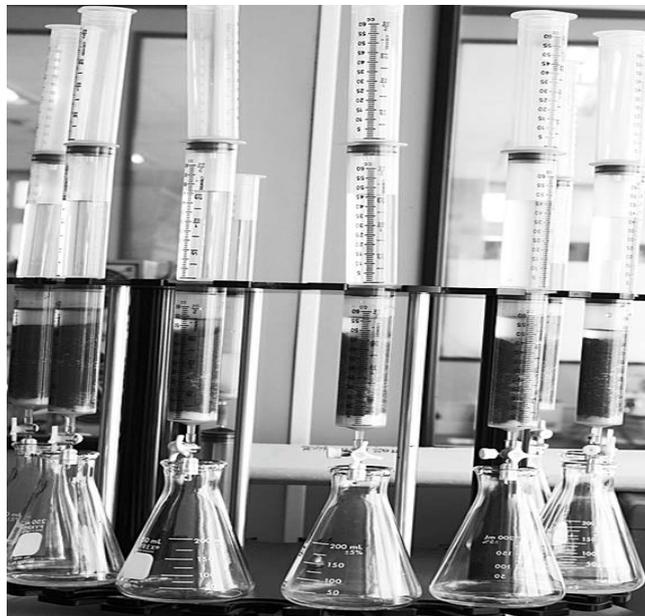
사진 4. Hybrid 비료 첨가 시 토양 중 MMT의 이동양상 조사장치.
