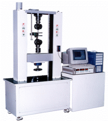
그림 3-7. Shear strength test model in the universal test machine united testing machine (UTM Shimadzu AG-2000A )
