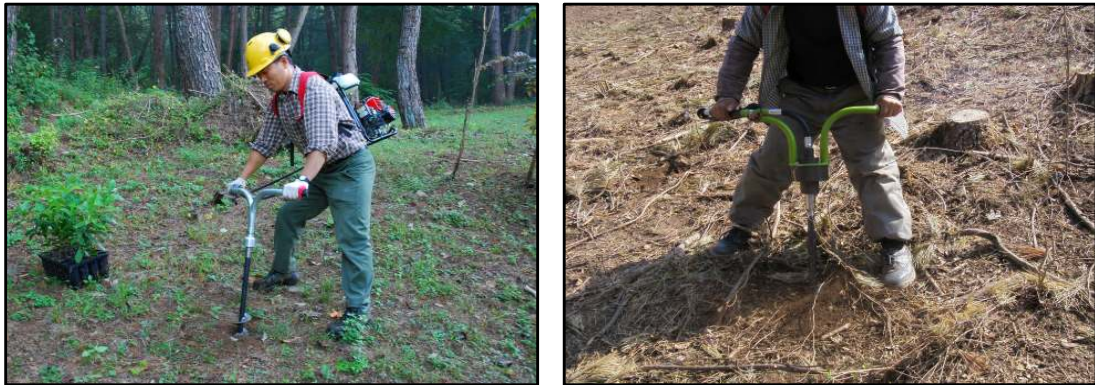
그림 6-13. 조림작업지에서의 휴대형 식혈기 작업
