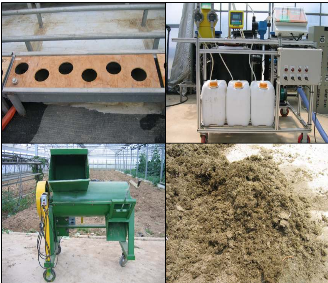
그림 7-3. 본 연구에 이용된 수경재배 및 암면분쇄 작업 시설(상좌; 베드, 상우; 배양액공급기, 하좌; 암면분쇄기, 하우; 분쇄된 암면)
