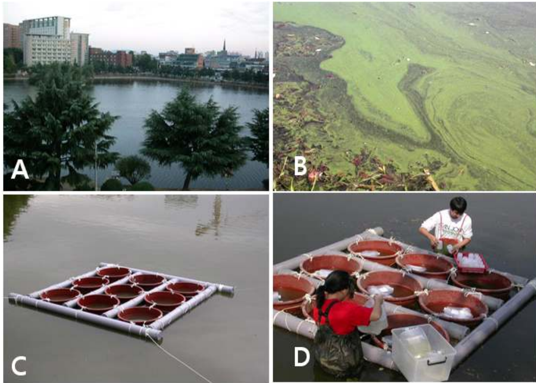
[그림 3.1.93] A: 일감호 전경, B: 남조류 대발생한 일감호, C: 일감호내 mesocosm D: 시료채취모습
