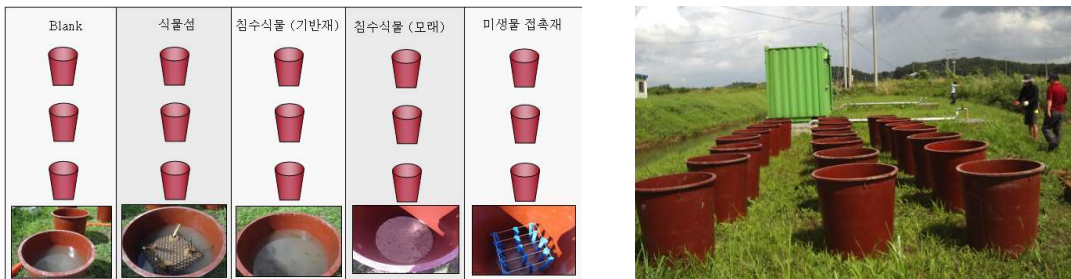
[그림 3.2.13] 미소유용생물 인공서식처 소재개발을 위한 실험구성 및 실험전경
