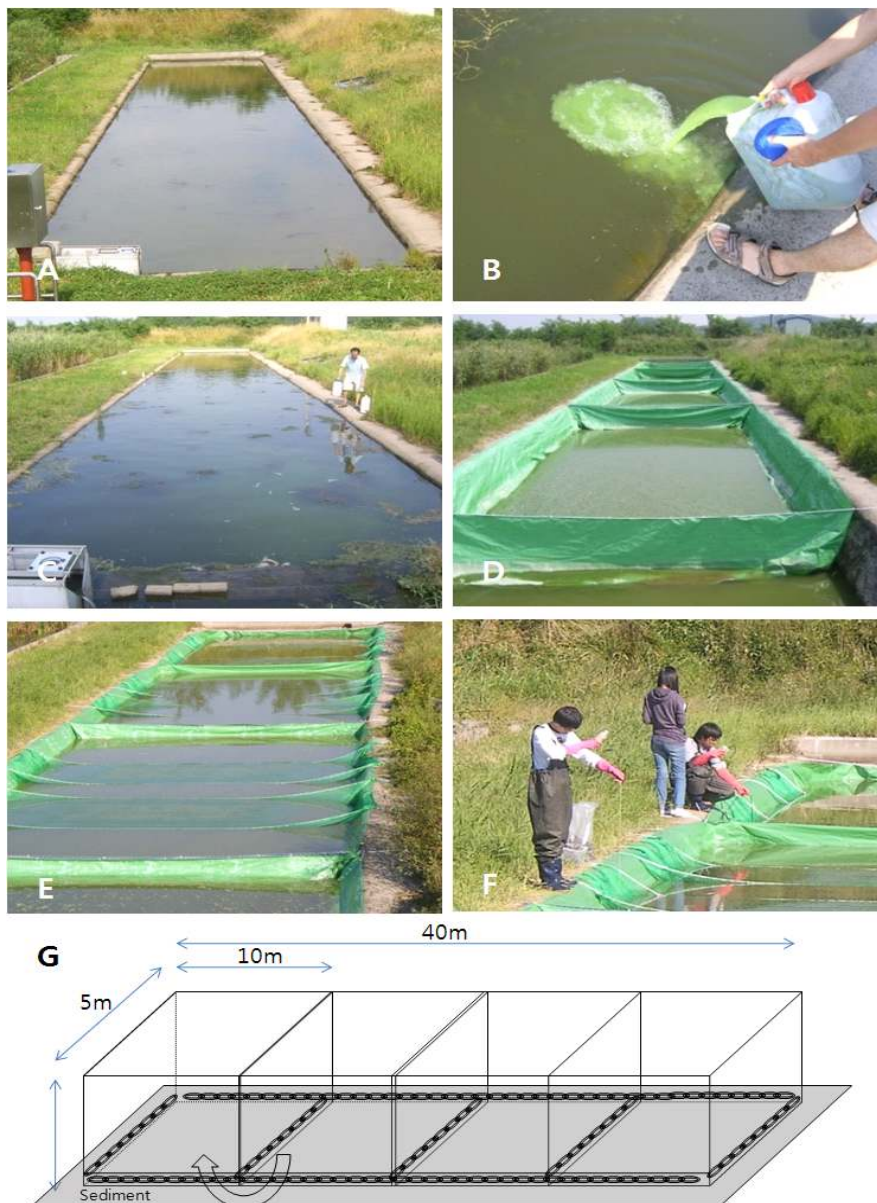
[그림 3.1.112] 석문시험포 mesocosm 설치 모습(A, B, C, D, E, F) 및 구조(G)
