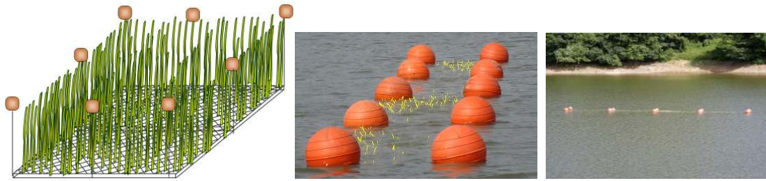
[그림 3.2.93] 부유형 호안수초대 개념도 및 설치전경
