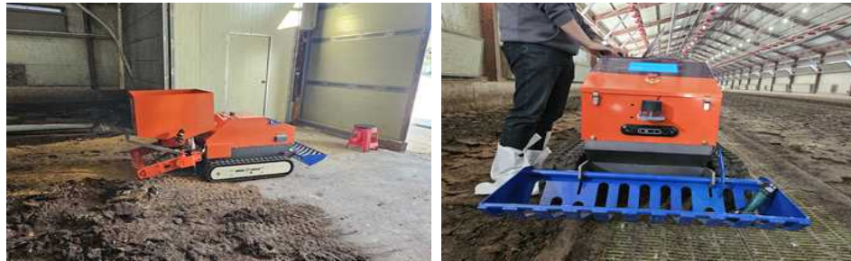
그림 75 2D 기반 LiDAR 기술 및 영상 카메라 탑재한 주행로봇 현장 시험
