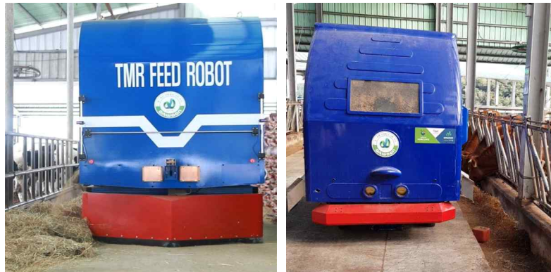
그림 14 무인 주행 기술이 적용된 우사용 급이로봇 사례(㈜다운 선행 개발)
