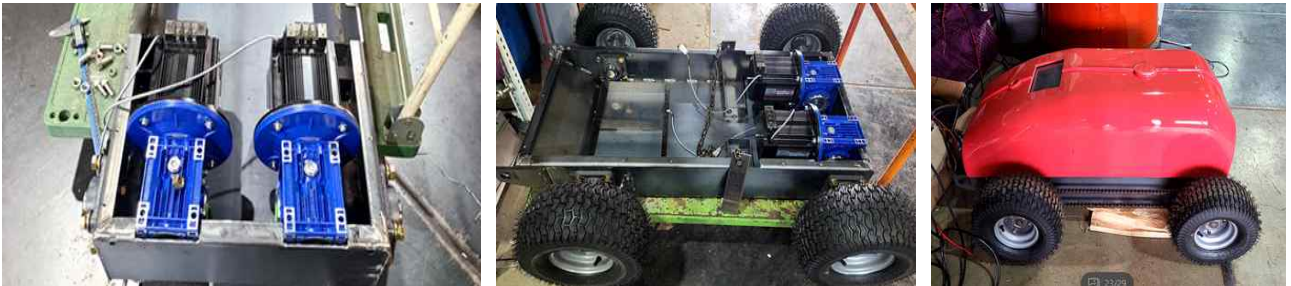
그림 94 4륜 구동 주행형 왕겨살포로봇 시작기 제작 및 조립
