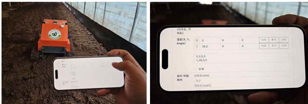
그림 36 오리로봇 주행 상태를 모니터링 및 원격제어 가능한 모바일 프로그램 개발
