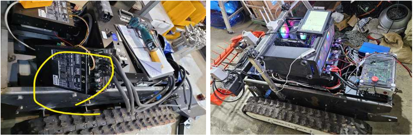
그림 52 왕겨살포로봇 상용모델용 배터리 결합, 모터드라이버 및 제어기 결선
