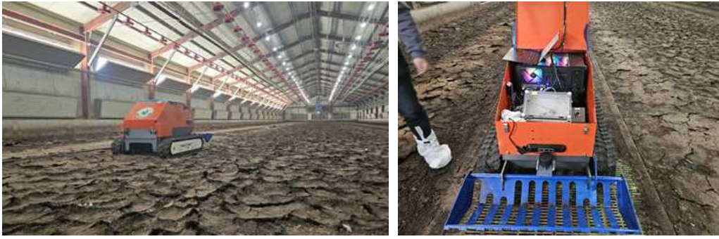
그림 77 벽면 거리 5500 mm 설정 후 주행 테스트, 내부 온도 이상 유무 검사
