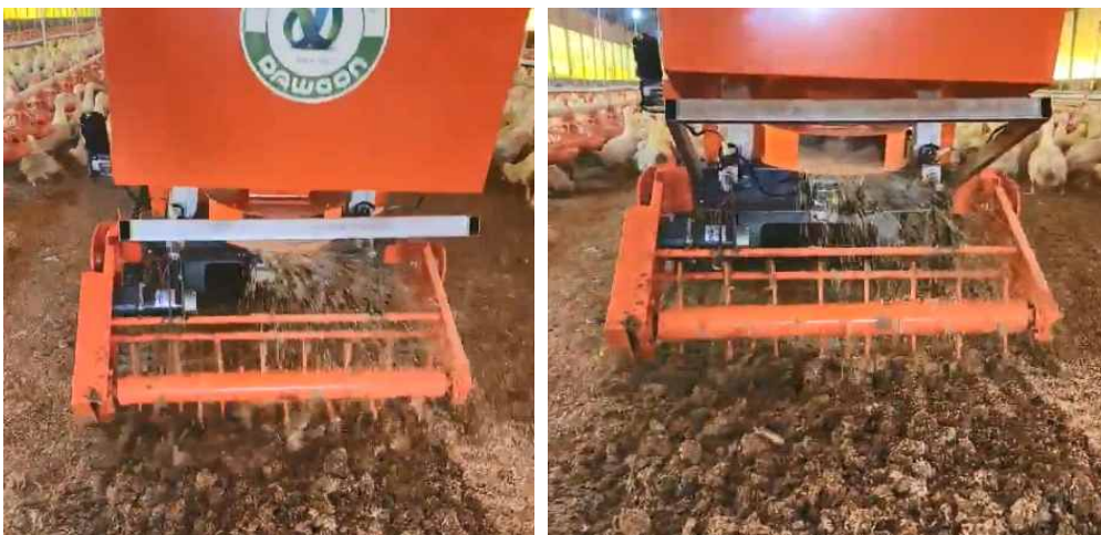
그림 89 오리 입식, 깔짚 살포로봇의 바닥 교반 기능 점검
