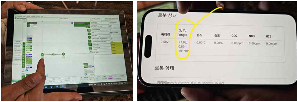
그림 37 태블릿 및 모바일을 통한 오리로봇의 현재 위치 표시
