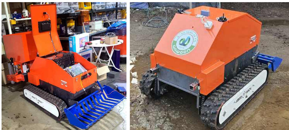
그림 55 왕겨살포로봇 상용모델 시작기의 전체 조립 및 도색
