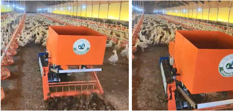
그림 88 오리 입식, 깔짚 살포로봇의 오리축사 내 시험 주행 기능 점검
