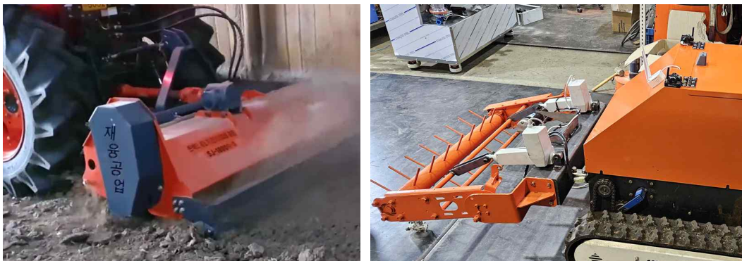
그림 81 중장비 로터리 교반 사례(좌), 오리주행로봇 교반기(우)
