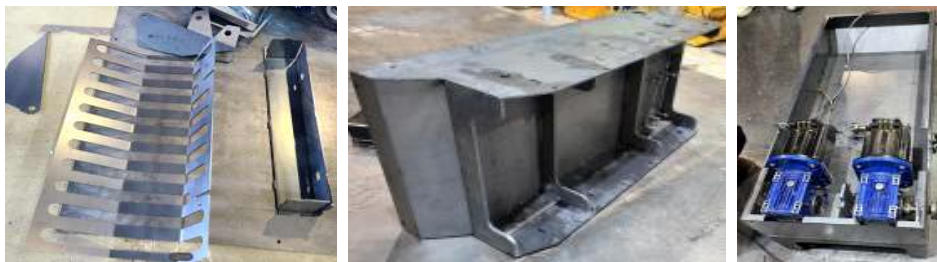
그림 50 왕겨살포로봇 상용모델 본체 부품 제작 및 조립
