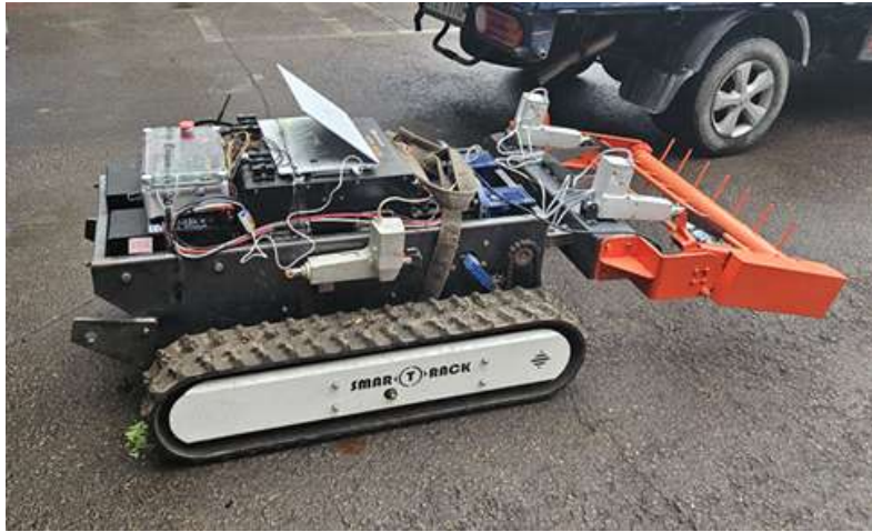
그림 33 GPS 기술을 이용한 로봇 자율주행 테스트
