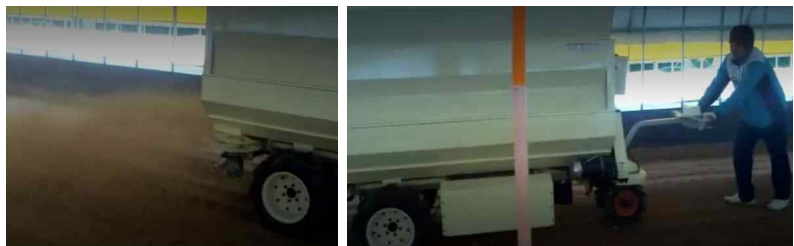
그림 2 노동자가 직접 운전하는 차량형 살포기를 이용한 살포 작업
