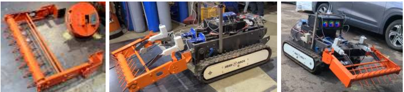
그림 53 왕겨살포로봇 상용모델 궤도, 교반기 조립 및 테스트 주행
