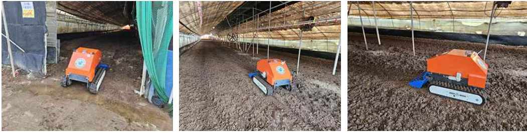
그림 69 오리 비입식, 분뇨 잔존 상태에서 GPS기반 자율 주행기능 점검
