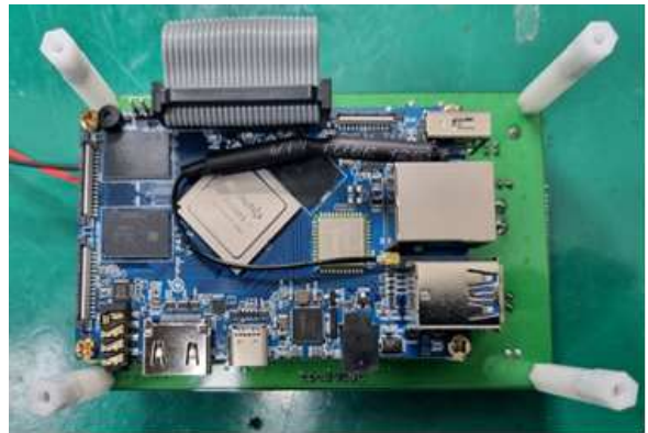
그림 27 OrangePi 및 베이스보드 결합
