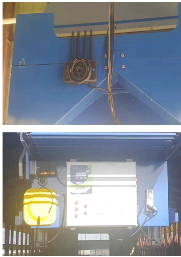
그림 15 왕겨살포로봇에 연동한 영상 장비(상), 센서 장비(하)
