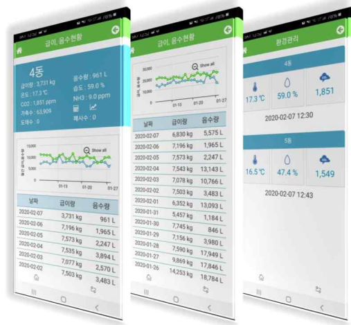
그림 16 축사 내 환경정보의 실시간 알림, 데이터 처리가 가능한 모바일 어플리케이션(android 전용)
