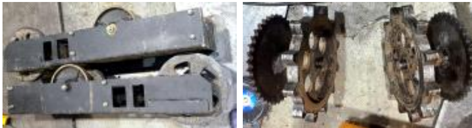
그림 51 왕겨살포로봇 상용모델용 궤도, 구동축 제작 및 조립
