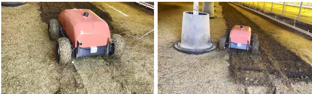
그림 98 4륜 구동형 왕겨살포로봇 일반 주행 상태(교반기 비장착)
