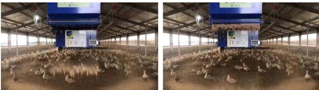
그림 8 현수형 왕겨살포로봇을 이용한 오리 축사의 왕겨 살포 현장
