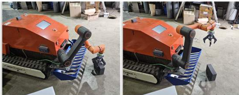
그림 83 AI를 통한 폐사체 수거 로봇 기능 개발 및 테스트 진행
