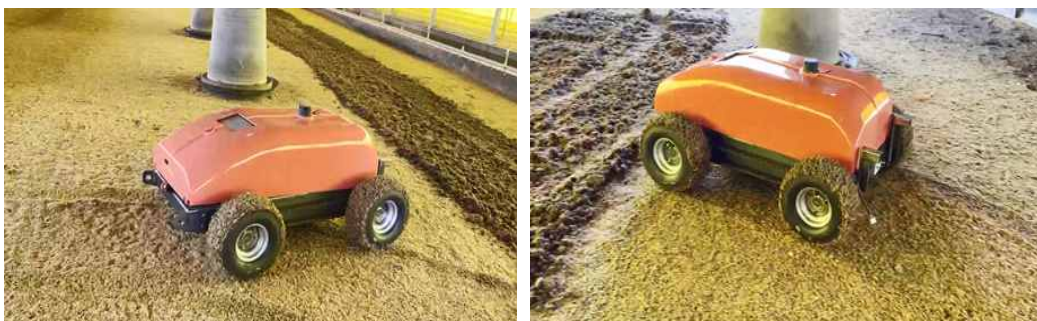
그림 99 4륜 구동형 로봇의 회전 및 오리사 바닥의 문제발생 상태
