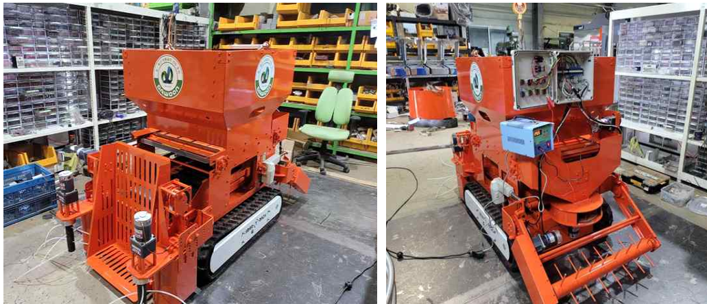
그림 39 기존 궤도 주행형 왕겨살포로봇
