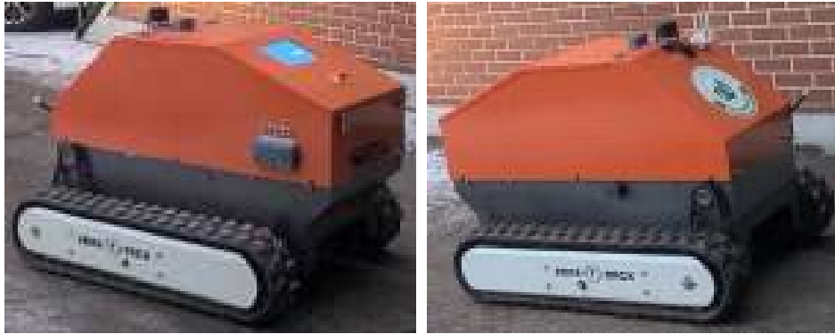
그림 56 왕겨살포로봇 상용모델 상단 커버 조립 및 테스트 주행
