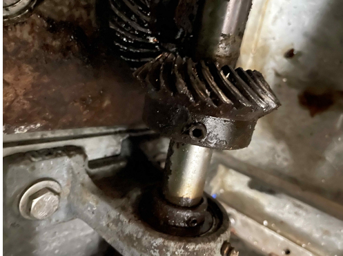
메인구동축 캠 파손
