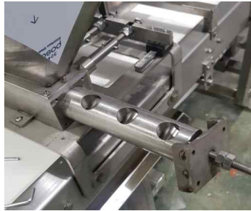
완전분해 청소가 가능한 구조 <유지 관리의 편의성을 고려한 구조>
