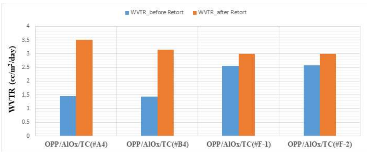
(b) Retort 테스트 전, 후의 수분투과도
