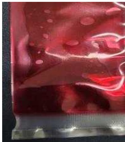
(그림 2-38) 사이드 하단 부 열눌림(외관) 및 누액 test 결 과 (양호)
