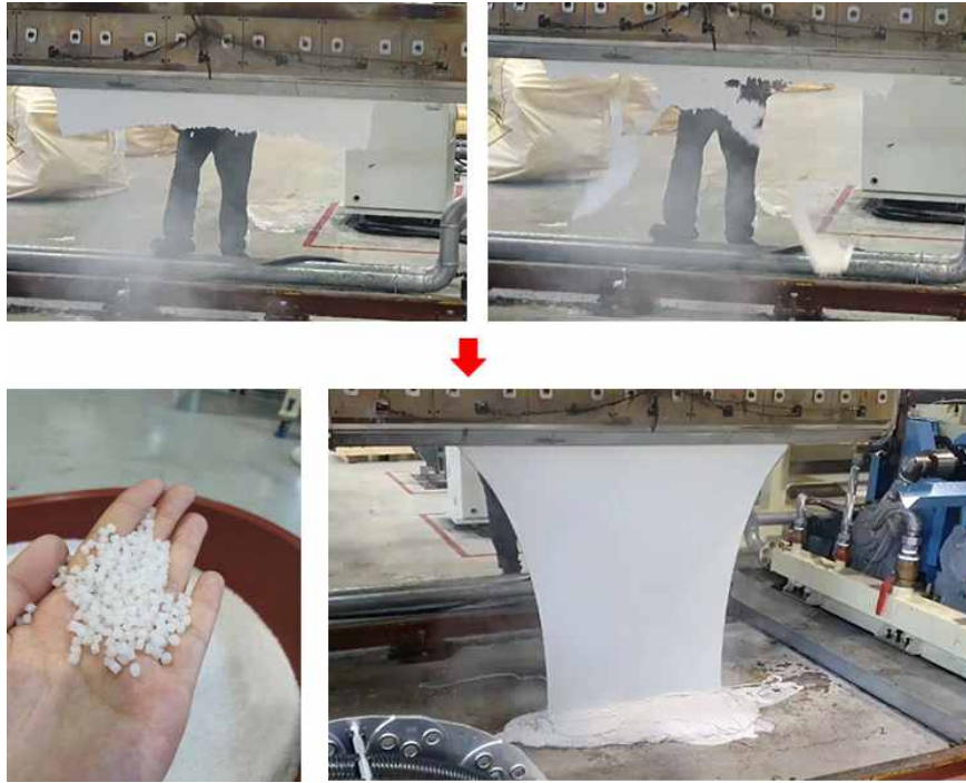
(그림 6-6) Nano 무기 Filler Compound PE Resin의 압출 현상 개선
