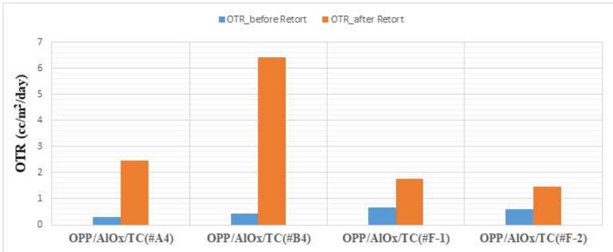
(a) Retort 테스트 전, 후의 산소투과도
