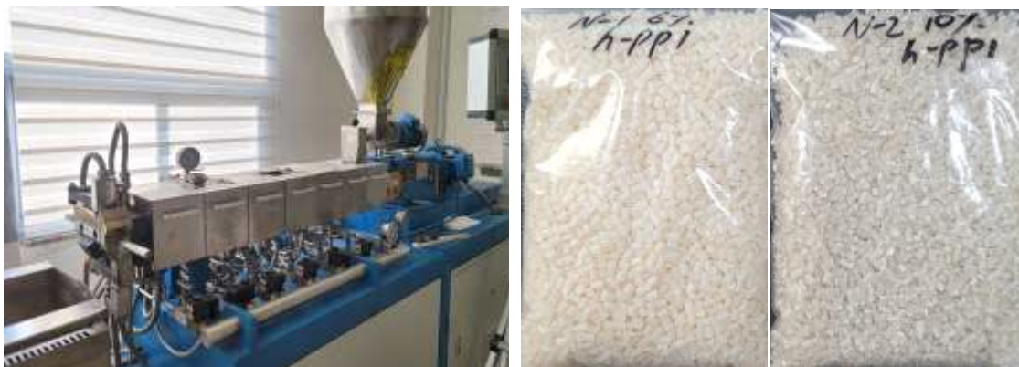
(그림 4-23) PP용 마스터배치 제조 장비 및 MB-1, MB-2
