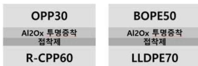
(그림 2-40) PP,PE 단일재질 식품포장재 구성(1차안)
