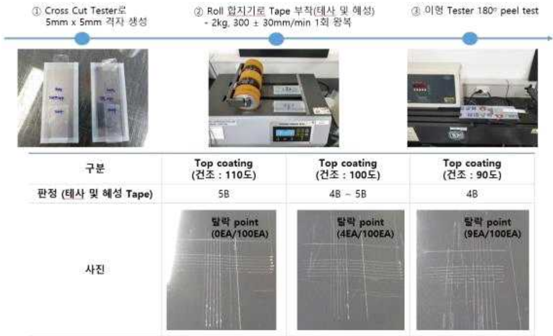
[그림2-9] Top coating제의 Cross cut test
