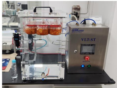
그림. 낙하시험 및 용기 누액 확인 사진
