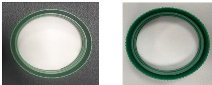
그림. 발포 PE (대조군)와 ZnO/TiO<sub>2</sub> + celite 복합필름
