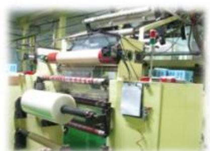
그림. 상향식 다층필름 압출공정 (Blow Inflation Film Extrusion process)
