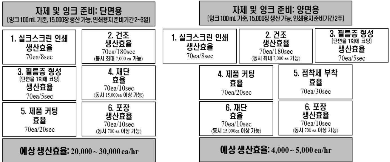
그림 22. 인쇄형 TTI 생산라인 개요도
