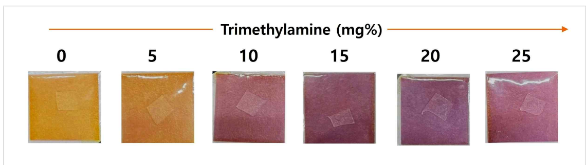
[그림12] Trimethylamine과 농도별로 반응한 신선도 가스지시계 위에서부터 Bromocresol green, Bromocresol purple, Alizarin
