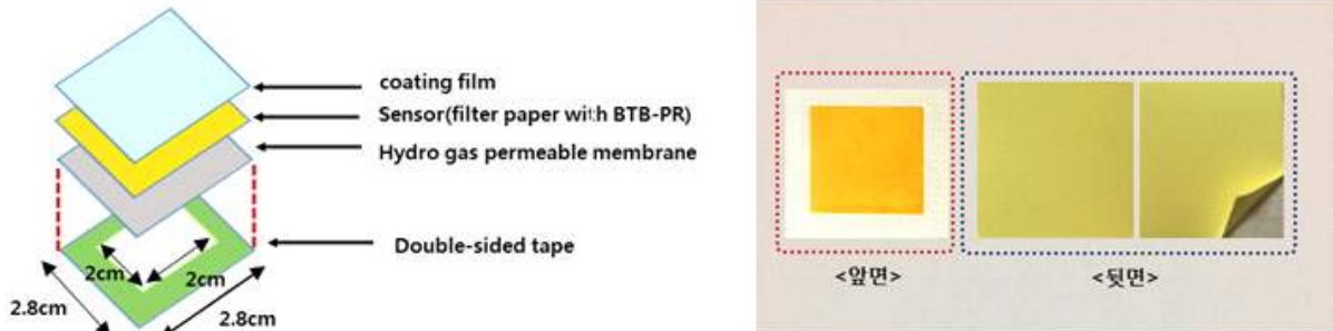
그림 1. 신선도 휘발성 염기질소(VBN) 가스지시계 제품 설계도
