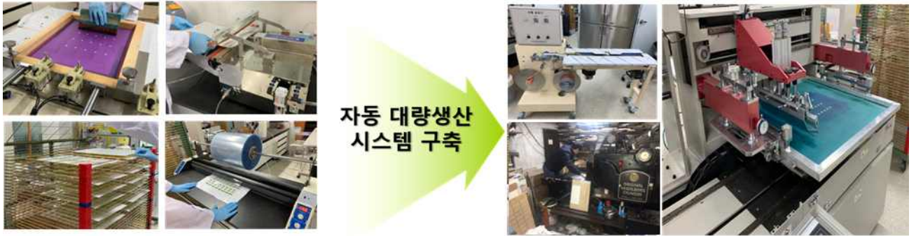
그림 26. 생산공정을 고려한 인쇄형 TTI 자동 대량생산 시스템
