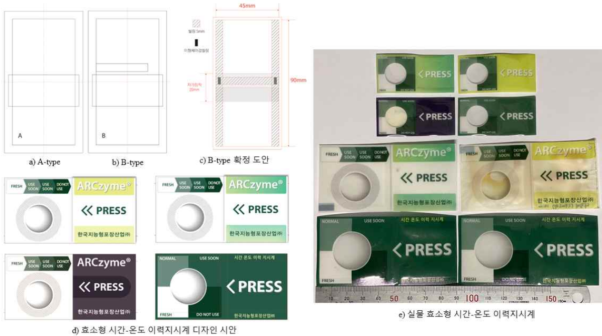
그림 17. 밸브형태 복합필름 적용 효소형 TTI 필름 제작을 위한 도안, 디자인 시안 및 실물
