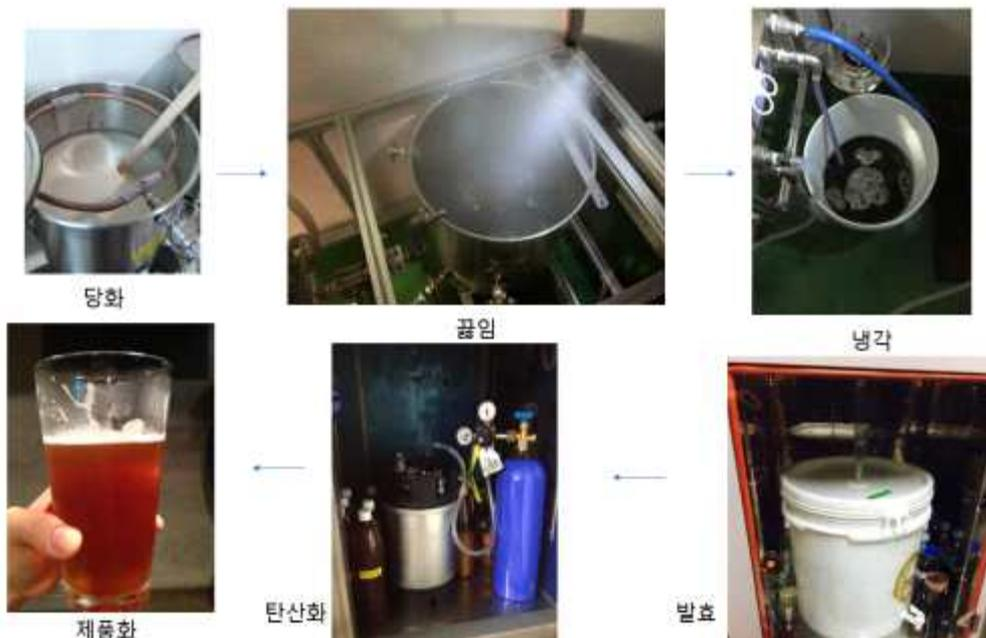
그림. 액상몰트 추출액을 이용한 실증작업 공정
