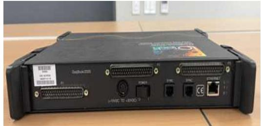
그림 2-117 센서 장기 측정 I/O 디바이스 모듈
