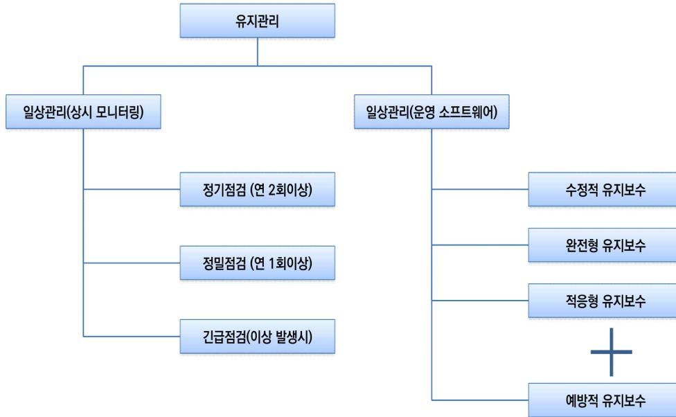
그림 2-148 연약지반 저수지 설계지원시스템 유지관리(안)
