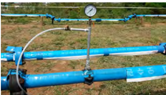
[그림 3-2-4-6] 누수감지 센서 작동 및 커버 수밀 실험 장치
