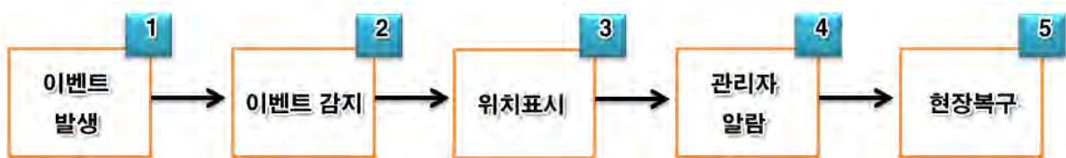
[그림 3-2-4-4] 관파손 감지시스템의 운영절차
