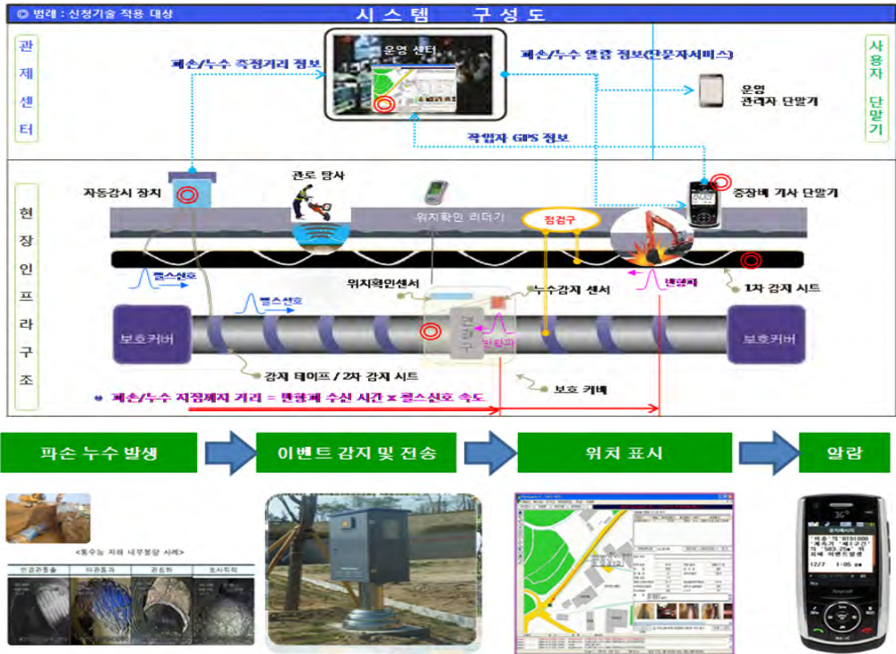
[그림 3-2-2-3] 관 파손 감지 시스템의 개념도
