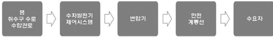
[그림 3-1-2-32] 관로내 발전 시스템의 원리 및 구조
