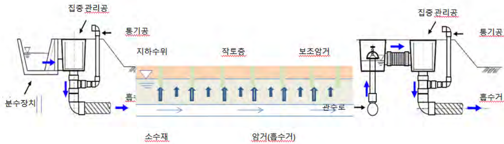
[그림 3-1-2-17] 급배수겸용 관개시스템 개념도
