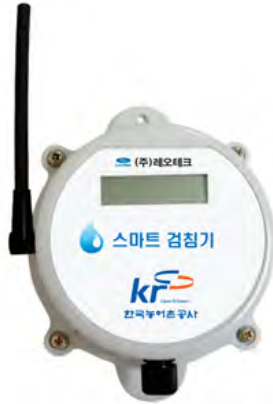
[그림 3-4-7-16] 스마트 검침기 시제품 제작
