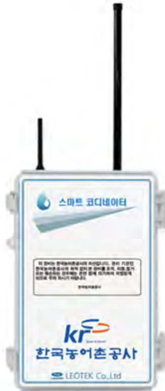
[그림 3-4-7-8] 스마트 코디네이터 시제품 제작
