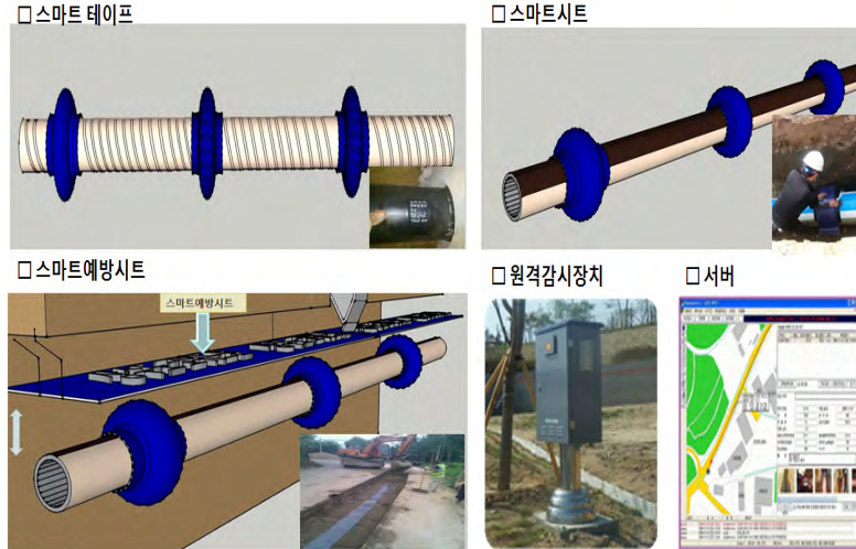
[그림 3-1-7-12] Smart Underground Navition System 설치 개념도
