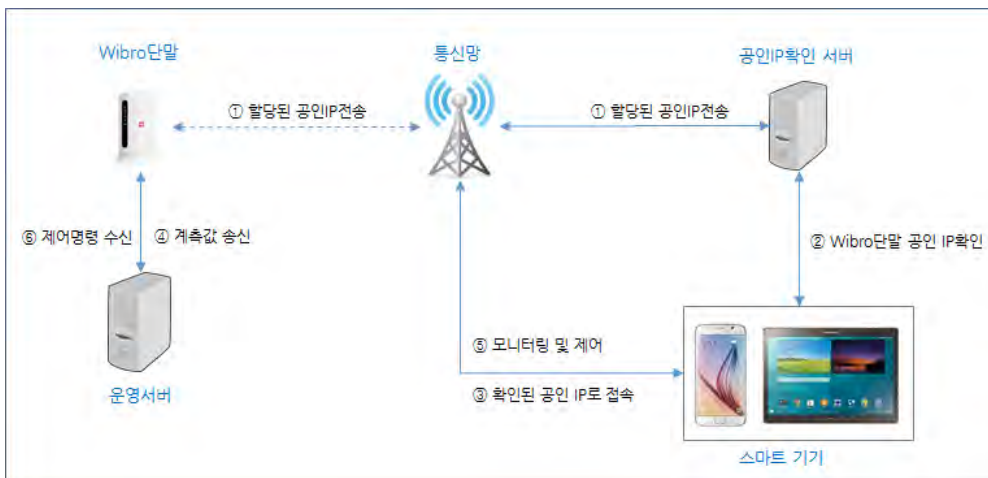
[그림 3-1-7-20] 통신망 구성 및 IP확인 절차 구성도
