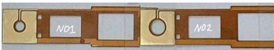
그림 58. RE, CE(Counter electrode) FPCB. 좌 No.1, 우 No.2.
